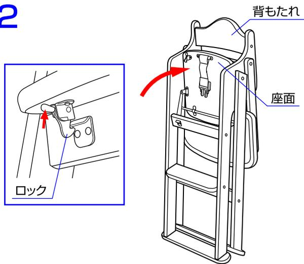
2. 座面裏側のロックを外し、背もたれを持って座面を矢印の方向に上げて折り畳んで下さい。
