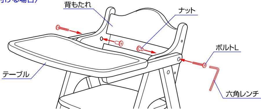
◇テーブルを取り付ける時は図のようにナットとボルトLを六角レンチで締めて取り付けして下さい。
