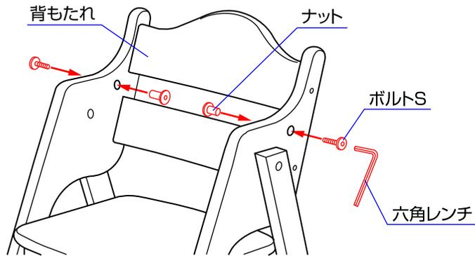
◇テーブルを取り付けない時は図のようにナットとボルトSを六角レンチで締めて穴をふさいで下さい。
