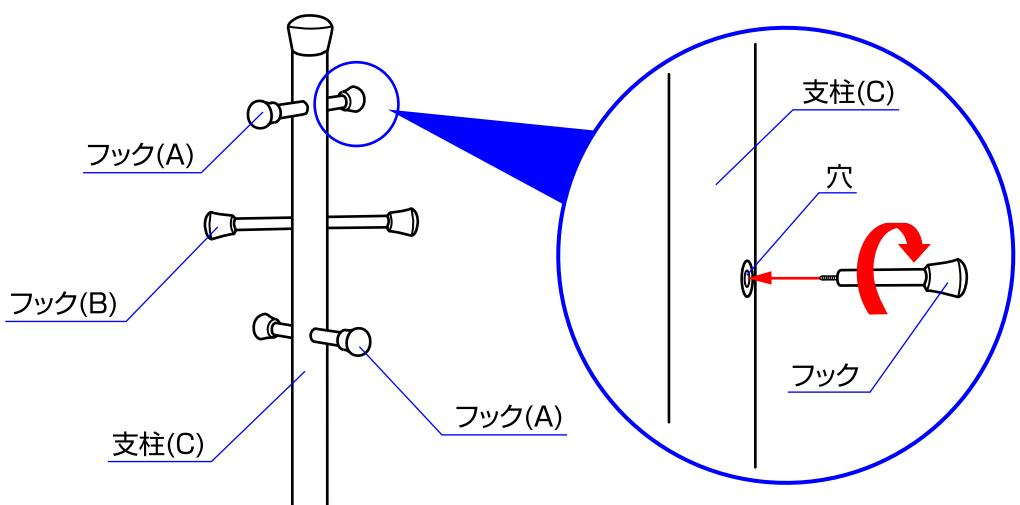
3. 支柱(C)の穴(6力所)に、フック(A)、フック(B)を取り付けて下さい。
