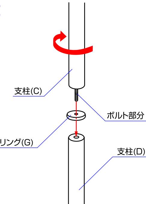
2. 支柱Cのボルト部分を、リングGを通して支柱Dに取り付けて下さい。
