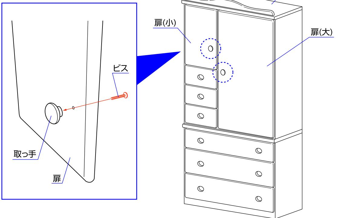
4.タンス上段の扉に取っ手をビスで取り付けて下さい。ビスはプラスドライバーで締めて下さい。(2箇所)
