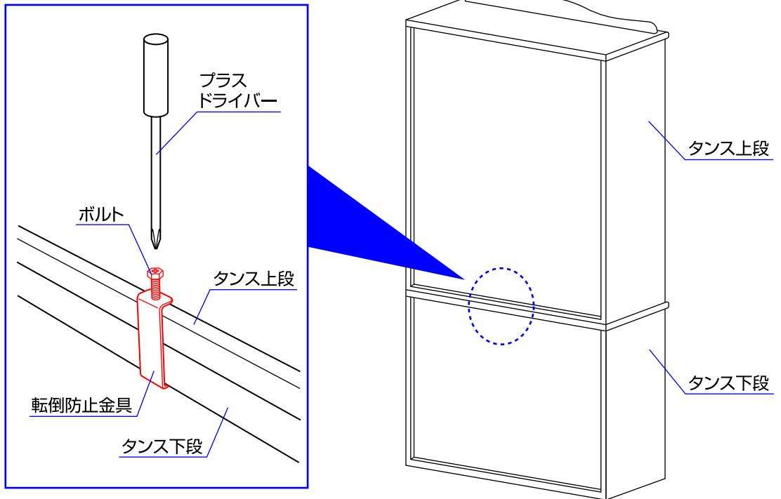
3.タンス上段/下段の後側のつなぎ目に転倒防止金具を噛ませて、ボルトをプラスドライバーで確実に締めて下さい。※転倒防止金具が確実に取り付けられていることを必ず確認して下さい。
