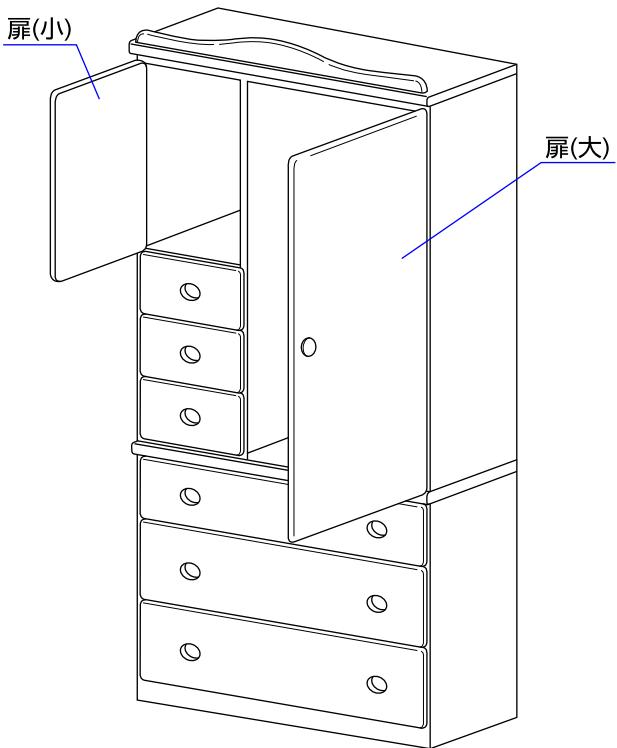
5.扉を開き、内側に金属ダボを差し込み、その上に棚板を取り付けて下さい。扉(小)の中には棚板(小)×1枚、扉(大)の中には棚板(大)×3枚をお好みの高さに取り付けて下さい。
