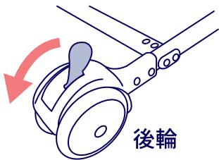
ラックを移動する時は、車輪ストッパーを矢印の方向に上げてロックを解除します。左右の後輪とも、行ってください。
