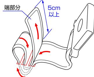
◇肩ベルトを腰ベルトに取り付けて股ベルトに差し込んで下さい。腰ベルトを取り外す時は股ベルトの解除ボタンを押して下さい。※本体の使用中は必ずシートベルトを締めて下さい。
