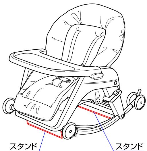
◇座面の高さを一番低くした状態でロッキング(揺れ)を止めてイスとして使用する場合には、前後に付いているスタンドを出して下さい。※座面の高さが一番低い時以外は必ずスタンドを収納するようにして下さい。
