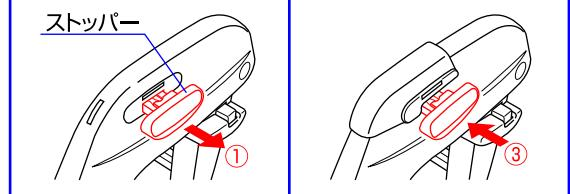
1. テーブルを取り付ける時は、①本体両側にあるストッパーを引き出して下さい。②テーブル裏側に付いているツメを本体両側の肘掛け穴に差し込み、③ストッパーをカチッと音がするまで押し込んで下さい。
