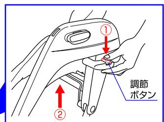
◇座面の高さを調節する時は、①本体の両側に付いている調節ボタンを押しながら、②本体を少し持ち上げてお好みの高さに調節して下さい。(5段階調節)
