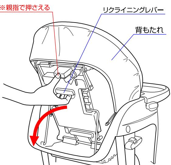
1.背もたれ裏側に付いているロックレバーを解除して下さい。※リクライニングしない時はロックレバーを必ずロックした状態にして下さい。
