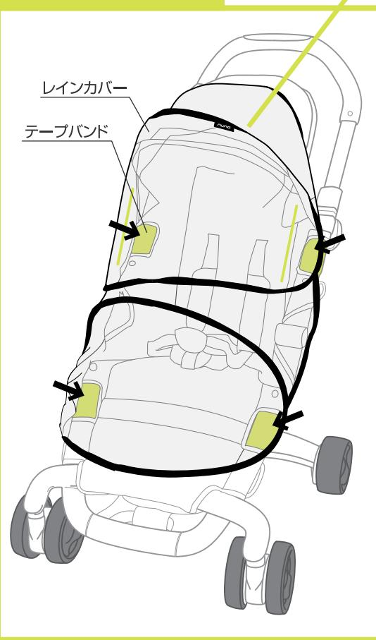
◇レインカバーをnunaタグが表側にくるようにベビーカーにかぶせて下さい。レインカバーのテープバンドをベビーカーのフレームに巻き付けて固定して下さい。(4箇所)※レインカバーが確実に取り付けられていることを必ず確認して下さい。
