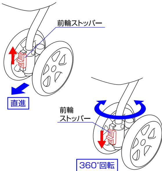
◇左右の前輪に付いている前輪ストッパーを上げると前輪の進行方向が固定されます。前輪ストッパーを下げると前輪が360°回転します。
