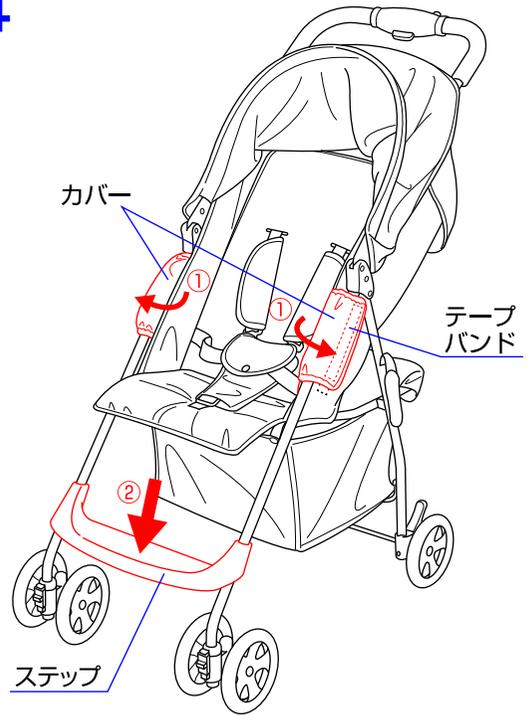
4. ①本体の両側にカバーをかぶせてテープバンドで固定して下さい。②ステップを下げて固定して下さい。
