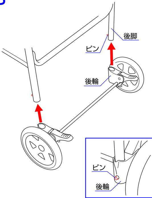
3. 本体両側の後脚に付いているピンを押さながら、後輪を後脚に差し込んで下さい。※後脚のピンが後輪から出ていることを必ず確認して下さい。
