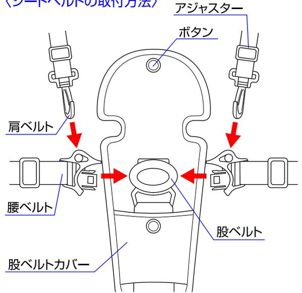
◇シートベルトを取り付ける時は、肩ベルトを腰ベルトに取り付け、股ベルトに差し込んで下さい。股ベルトカバーを閉じてボタンで固定して下さい。肩ベルト、腰ベルトの長さを調節する場合は、アジャスターを使用してお子様の体格に合った長さになるよう調節して下さい。
