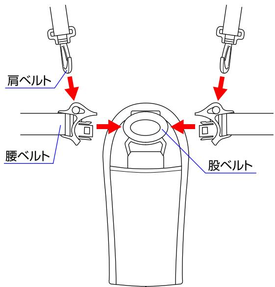
◇腰ベルトを取り外す時は、股ベルトの解除ボタンを押して取り外して下さい。
