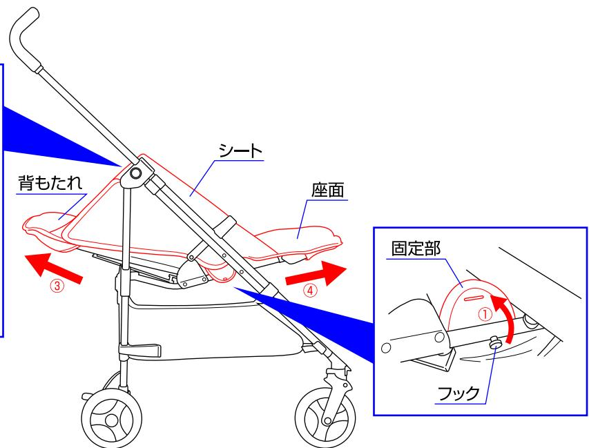
3. ①シートの両側にある固定部をフックから外して下さい。②シートの両側にある芯部を本体から抜き取って下さい。
