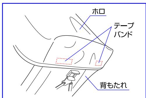
4. ホロを本体に取り付ける場合は、①ホロの両端部分を本体のジョイント部にスライドさせて取り付けて下さい。
