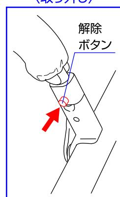
5. ガードの両端を本体のソケットに差し込んで下さい。※ガードのピンがソケットの穴から出ていることを必ず確認して下さい。ガードを取り外す場合はガードの解除ボタンを押して下さい。
