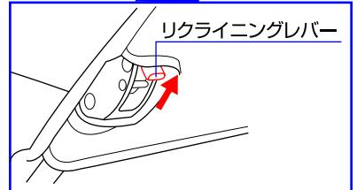
◇背もたれを倒す時は背もたれ後部にあるリクライニングレバーを上げて倒して下さい。(4段階調節)
