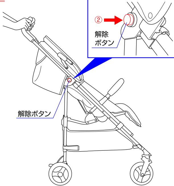
1. 本体を折畳む場合は、①折畳みレバーを上げて下さい。②本体の両側にある解除ボタンを押して下さい。
