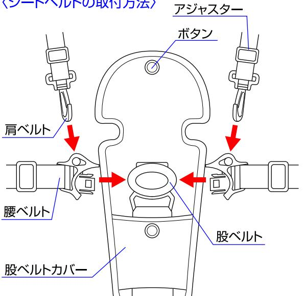
◇シートベルトを取り付ける時は、肩ベルトを腰ベルトに取り付け、股ベルトに差し込んで下さい。股ベルトカバーを閉じてボタンで固定して下さい。肩ベルト、腰ベルトの長さを調節する場合は、アジャスターを使用してお子様の体格に合った長さになるよう調節して下さい。
