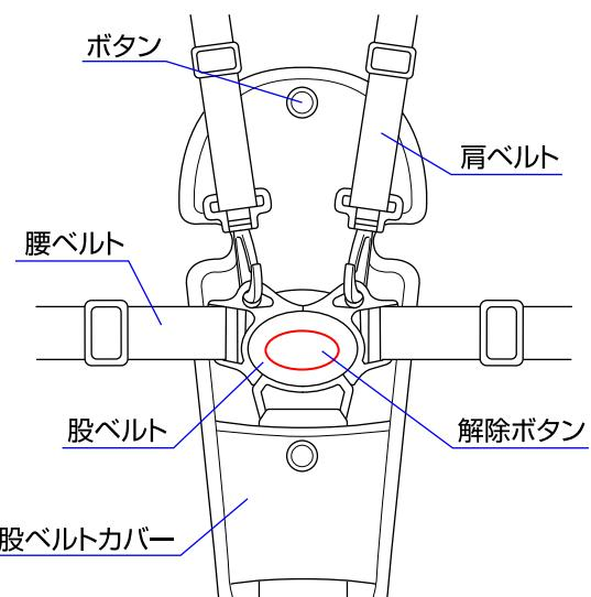
◇股ベルトカバーのボタンを外して開けて下さい。腰ベルトを取り外す時は、股ベルトの解除ボタンを押して取り外して下さい。
