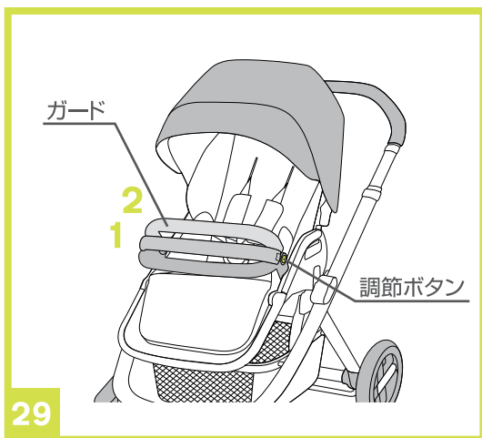
29. ガードの両側に付いている調節ボタンを押すとガードの高さを調節することができます。(2段階調節)
