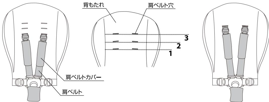
13.肩ベルトの高さは3段階に調節できます。※肩ベルトの高さを調節する場合は、肩ベルトカバーの高さも一緒に調節して下さい。
