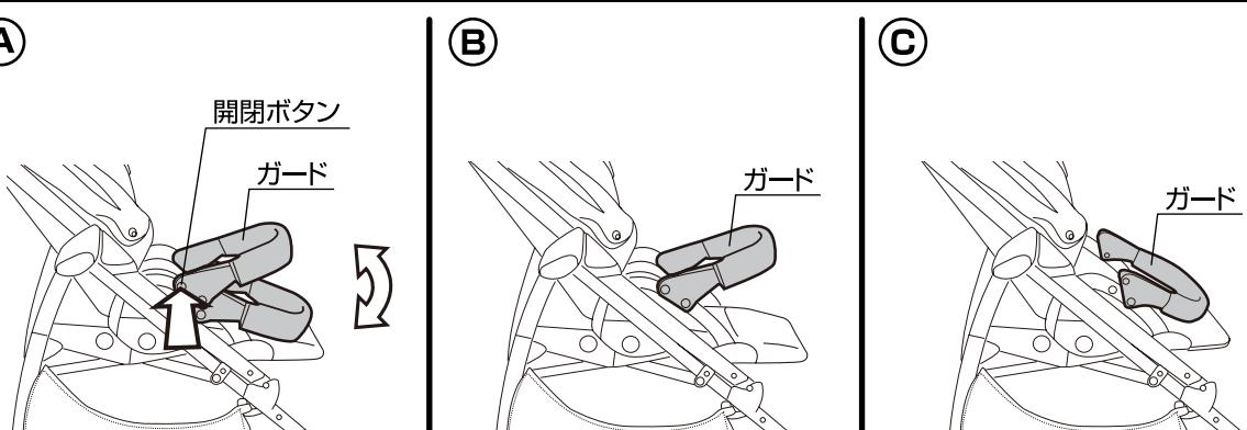
6.(A)両側の開閉ボタンを押すとガードを開閉することができます。(B)ベビーカーを使用する場合はガードを閉めた状態にして下さい。
