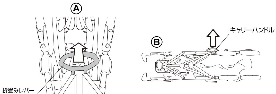
21.(A)折畳んだベビーカーは折り畳みレバーを持って引いて運ぶことができます。※その場合、両側の前輪ストッパーを上げて前輪の向きを固定して下さい。(P4.図5-B参照)
