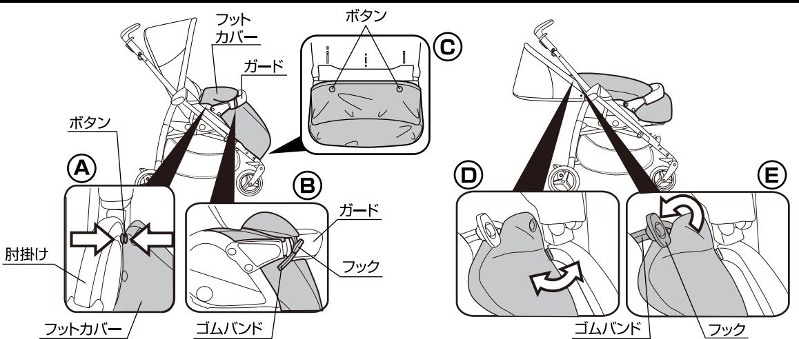
9.(A)フットカバーの両側に付いているボタンを肘掛けの内側に付いているボタンに取り付けて下さい。(B)フットカバーの両側に付いているフックをガードに巻いてゴムバンドに取り付けて下さい。(C)座面の裏側のボタンに取り付けて下さい。(D)フットカバーをもっと深くかぶせる場合は、フックをゴムバンドから外し、(E)フックを奥に付いているゴムバンドに取り付けて下さい。
