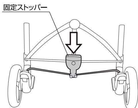
2.(C)座面の両端を上から押し、本体両側の固定フレームがソケットに取り付けられていることを必ず確認して下さい。
