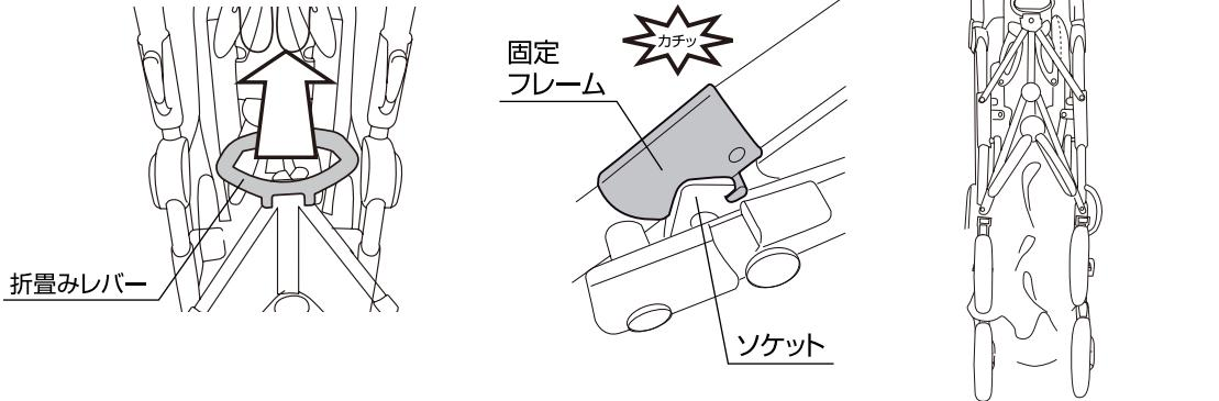
19.片手でハンドルを持ったまま、折畳みレバーを引いて本体を折り畳んで下さい。※固定フレームがソケットに確実に取り付いていることを必ず確認して下さい。
