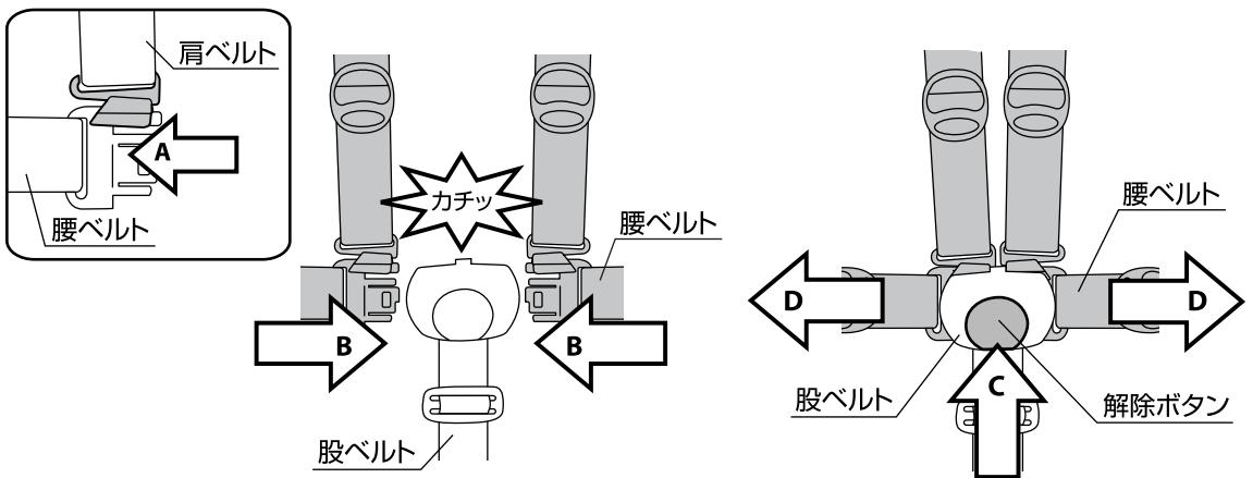
11. シートベルトを取り付ける時は、(A)肩ベルトを腰ベルトに通して下さい。(B)腰ベルトを股ベルトに差し込んで下さい。
