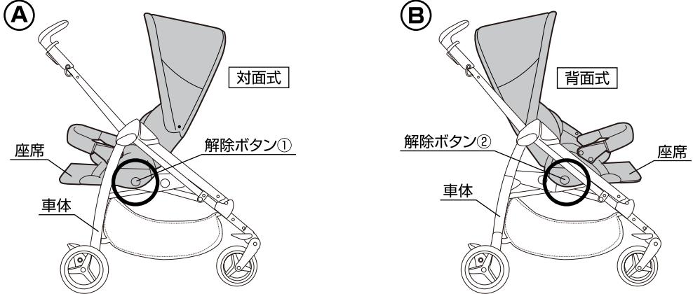
16.(A)座席を対面式→背面式に変更する場合は、車体の両側に付いている解除ボタン①を押して座席を取り外して下さい。
