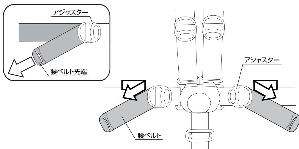
12. 腰ベルトの長さを調節する場合は、両側の腰ベルトの先端をアジャスターから引っ張り調節して下さい。
