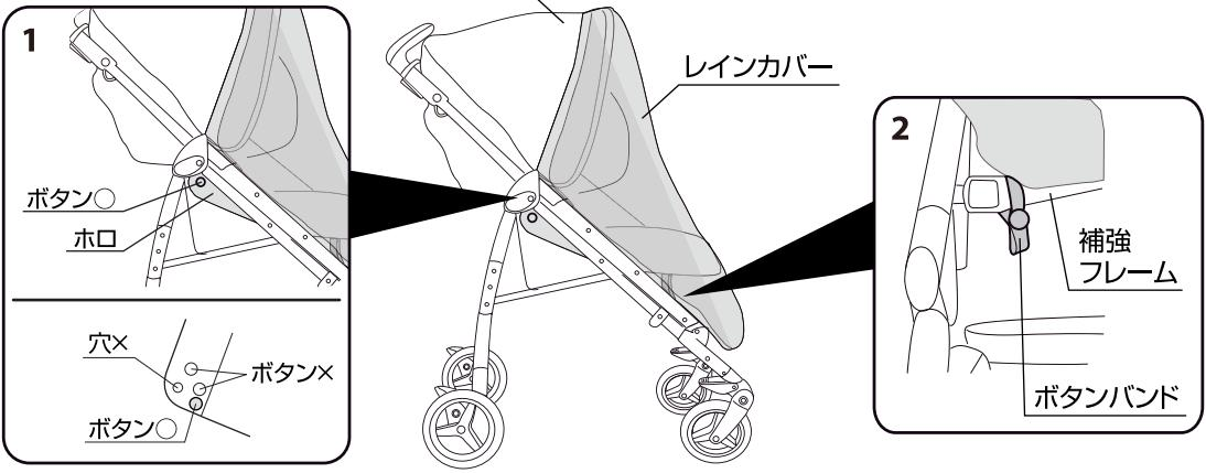
10. ①本体のホロを広げてレインカバーをかぶせて下さい。レインカバーの両側のボタン○をホロのボタンに取り付けて下さい。
