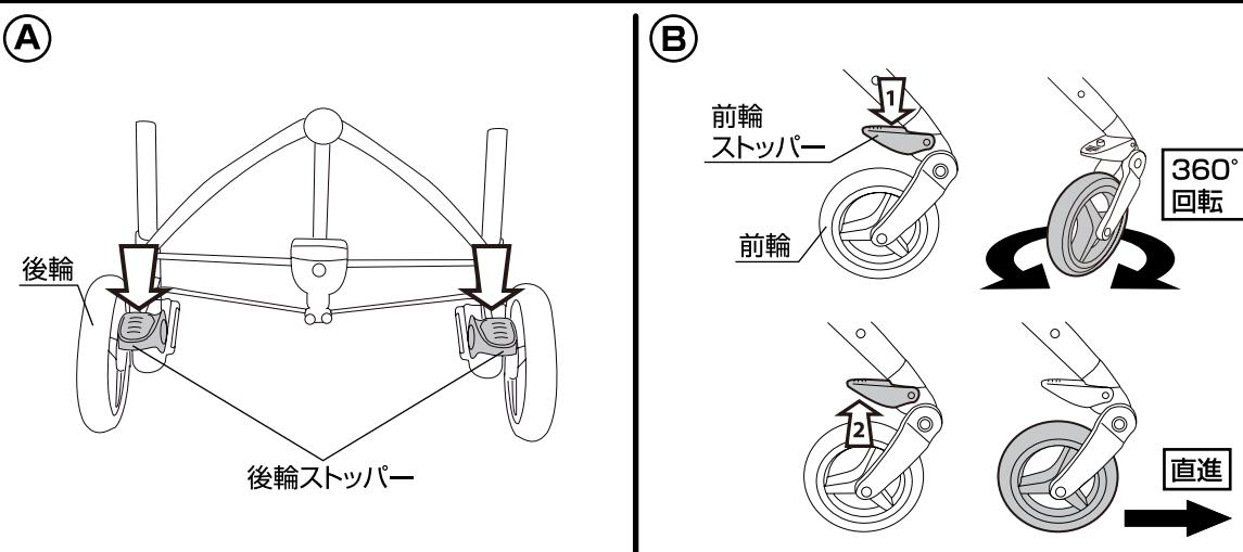
5.(A))後輪ストッパーを下げる時後輪がロックされます。※お子様が乗り降りする場合は必ず後輪ストッパーをロックして下さい。
