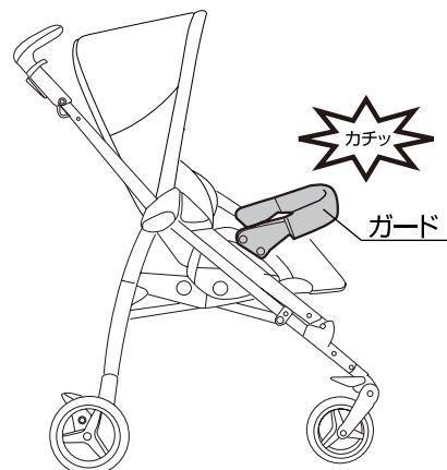
3.(E)両側に付いている開閉ボタンを押しながら、ガードを上げて固定して下さい。
