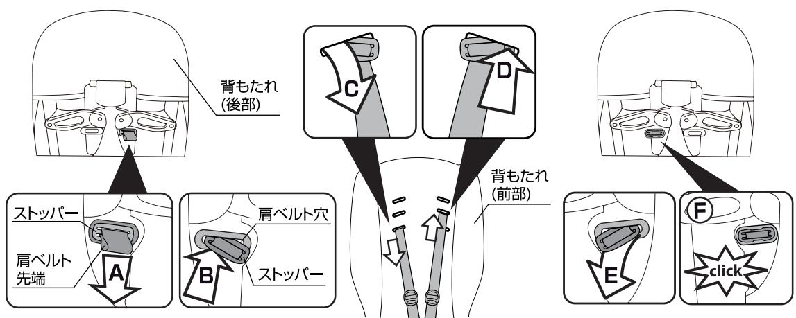
14.肩ベルトの高さを調節する場合は、(A)背もたれ後部から肩ベルトの先端を引っ張りストッパーを取り外し、(B)ストッパーを肩ベルト穴に通して、(C)背もたれの前部から出して下さい。(D)お好みの高さの肩ベルト穴に通し、(E)背もたれの後部から出して下さい。(F)ストッパーを肩ベルト穴に取り付けて下さい。※肩ベルトの高さは必ず両側とも同じ高さにして下さい。
