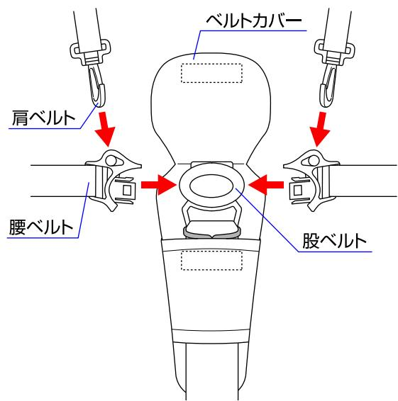
◇腰ベルトを取り外す時はベルトカバーを開き、股ベルトの解除ボタンを押して取り外して下さい。
