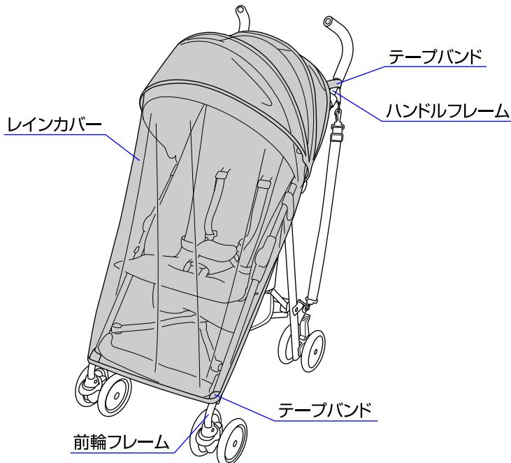
◇本体のホロを開いた状態でレインカバーをかぶせて下さい。本体両側の前輪フレーム、ハンドルフレームにテープバンドを巻き付けて固定して下さい。※レインカバーが確実に取付けられていることを必ず確認して下さい。
