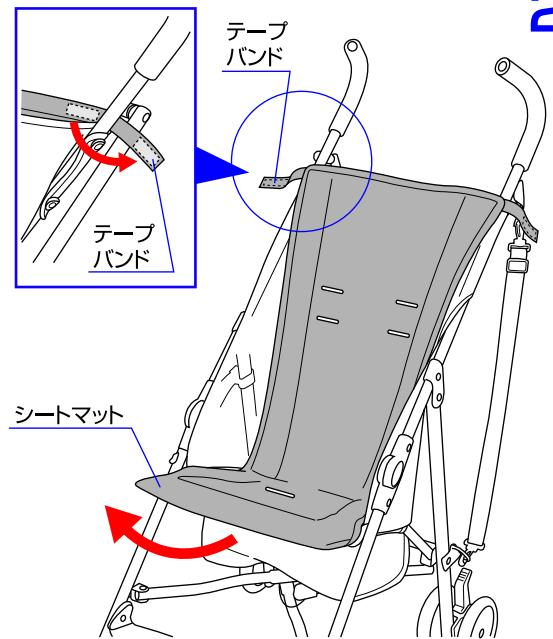
1.シートマットを取り外す場合は、シートベルトを全て外し、肩ベルト、股ベルトをシートマットから抜き取って下さい。
