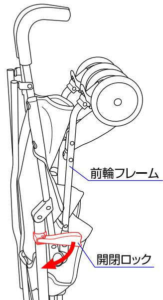
1.両側の前脚フレームに前輪を差し込み取り付けて下さい。
