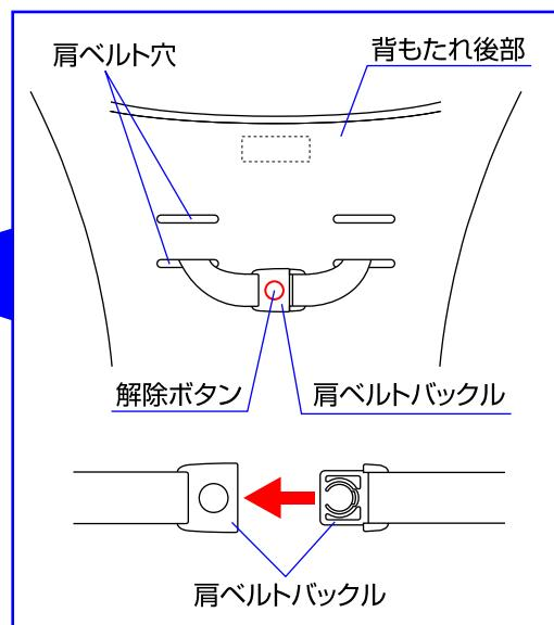
◇肩ベルトの高さを調節する場合は、本体の背もたれ後部から出ている肩ベルトバックルの解除ボタンを押して取り外して下さい。高さを調節した後、肩ベルトバックルを組み合わせて下さい。(2段階調節)
