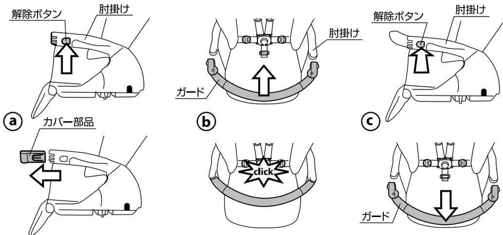
7.(a)肘掛けの両側に付いている解除ボタンを押してカバー部品を取り外して下さい。(b)ガードを肘掛けの先端に差し込んで下さい。(c)ガードを取り外す時は肘掛けの両側に付いている解除ボタンを押して下さい。※ガードが確実に取り付けられていることを必ず確認して下さい。
