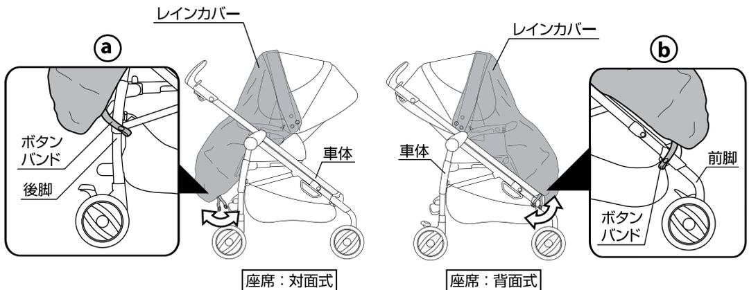
24. 座席を車体に対面式で取り付けた場合、(a)レインカバーの下部にあるボタンバンドを後脚に取り付けて下さい。座席を車体に背面式で取り付けた場合、(b)レインカバーの下部にあるボタンバンドを前脚に取り付けて下さい。
