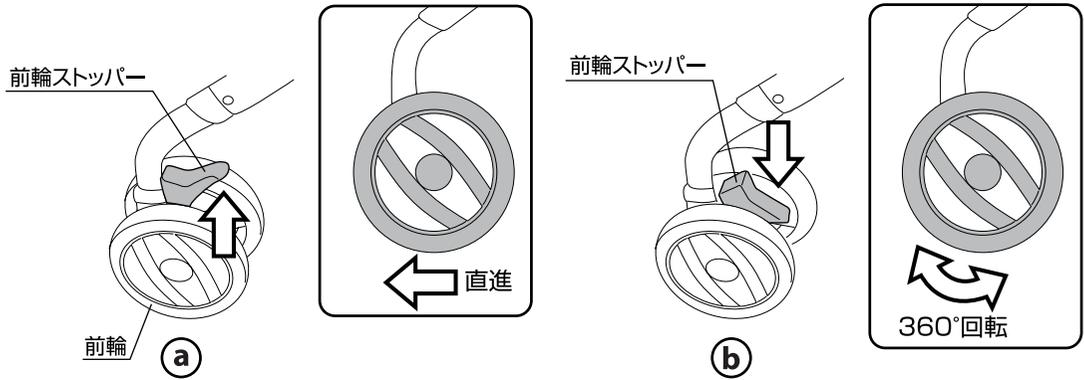
13.(a)前輪ストッパーを上げると進行方向が固定されます。(b)前輪ストッパーを下げると前輪は360°回転し、色々な方向へ進むことができます。
