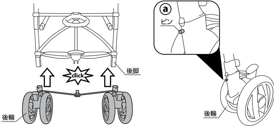
4. 後輪を図の向きで後脚に差し込んで下さい。後輪の穴から(a)のように後脚のピンが出ていることを必ず確認して下さい。
