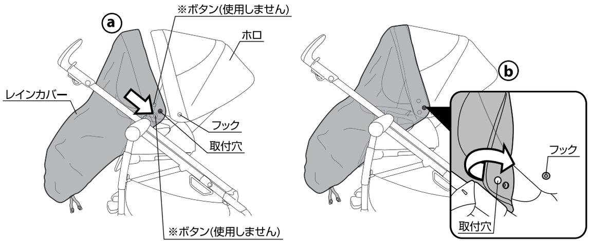
23. レインカバーの左右の取付穴をホロの両側にあるフックに取り付けて下さい。
