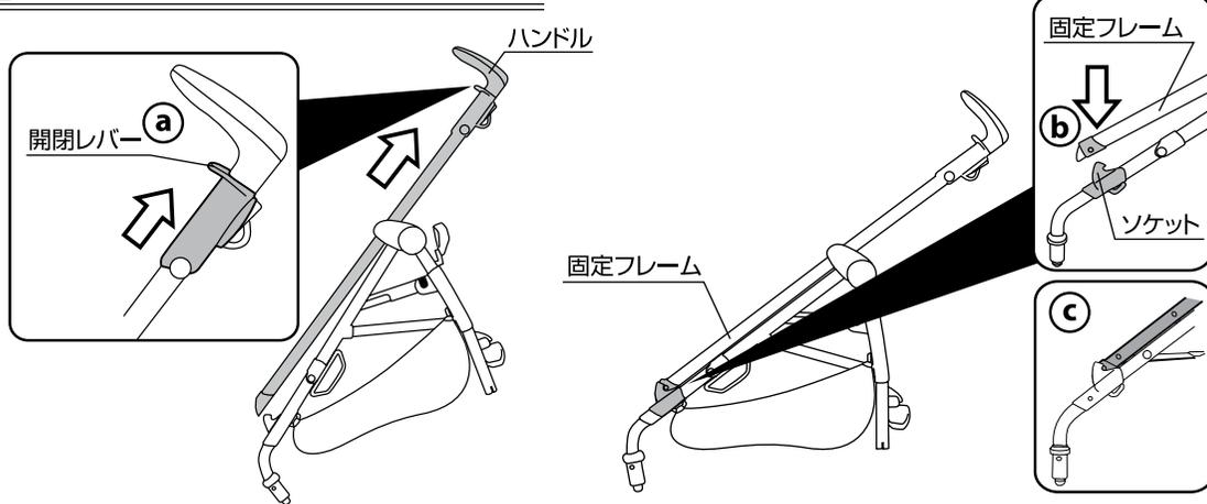
2.(a)のように両側のハンドルに付いている開閉レバーを引き、ハンドルを上げて本体を開いて下さい。(b)→(c)のように両側の固定フレームをソケットに取り付けて下さい。\*本体が確実に開いていることを必ず確認して下さい。\*ベビーカーの開閉の際にお子様指等をはさむ危険性がありますので、お子様を近づけないようにして下さい。
