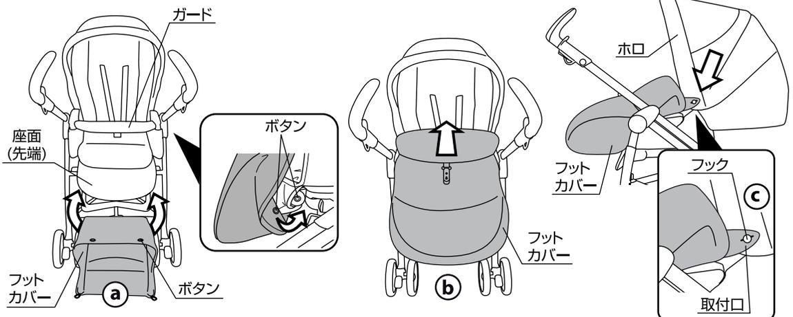
21.フットカバーを取り付ける場合は、(a)フットカバーを座面(先端)にかぶせ、フットカバーのボタンを座面(先端)の裏側(2カ所)、横側(2カ所)に取り付けて下さい。(b)ガードの上にかぶせて下さい。(c)フットカバーの両側の取付口をホクの両側のフックに掛けて下さい。
