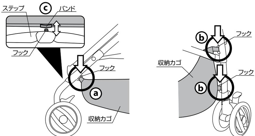
6. 収納カゴを本体両側、ステップのフック(a)(b)(c)に引っ掛けて下さい。(計7箇所)
