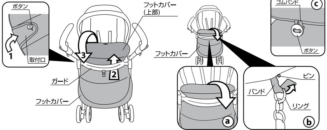
22. フットカバーの上部をガードに巻く場合は、図20で掛けたフットカバー両側の取付口をフックから外し、①取付口をボタンに取り付けて下さい。(a)フットカバーの上部をガードの下から巻いて下さい(②→③)。(b)フットカバーのバンドをリングに通し、バンドをピンに取り付けて下さい。※「41199/PLIKO SWITCH COMPACT Denim」の方は(c)のようにボタンにゴムバンドを掛けて下さい。
