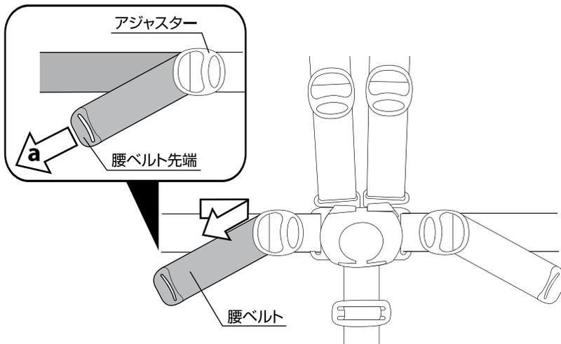
19.(a)腰ベルトの長さを調節する場合は、両側の腰ベルトの先端をアジャスターから引っ張り調節して下さい。
