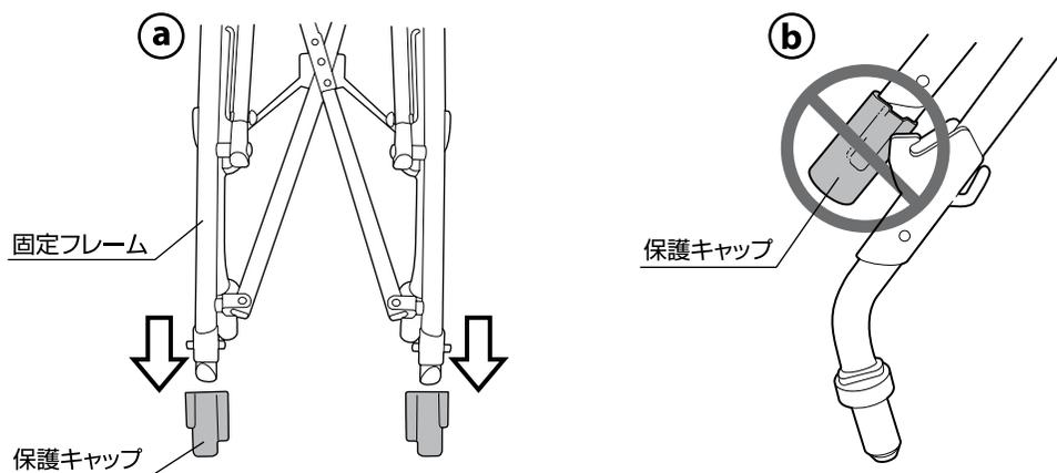
1.(a)のように両側の固定フレームに付いている保護キャップを取り外して下さい。(b)のように保護キャップが付いたままでは本体を開くことはできません。保護キャップは使用しませんので処分して下さい。
