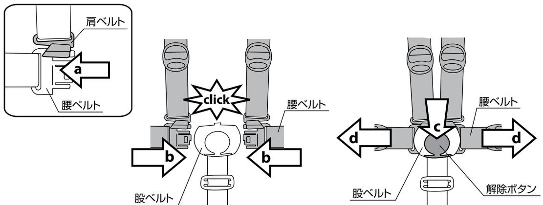
18.シートベルトを取り付ける時は、(a)肩ベルトを腰ベルトに通して下さい。(b)腰ベルトを股ベルトに取り付けて下さい。
