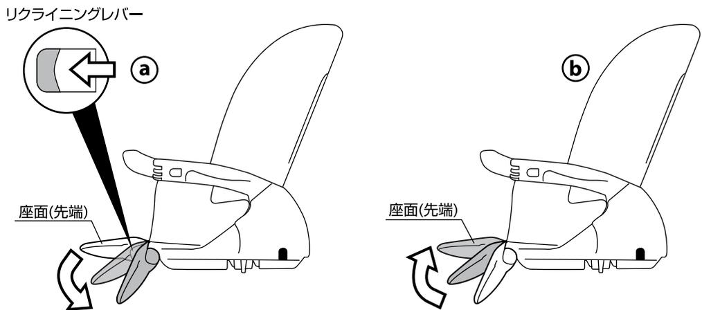
17.(a)座面(先端)の両側に付いているリクライニングレバーを引くと、(b)座面(先端)の高さを調節することができます。(3段階調節)
