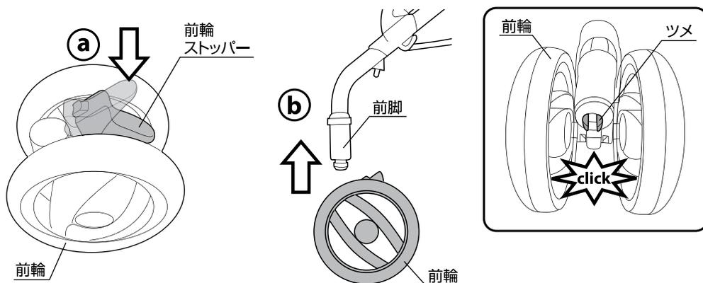
3.(a)前輪ストッパーを下げた状態にして下さい。(b)前輪2個を本体両側の前脚に差し込んで下さい。(c)前輪から前脚のツメが出ていることを必ず確認して下さい。
