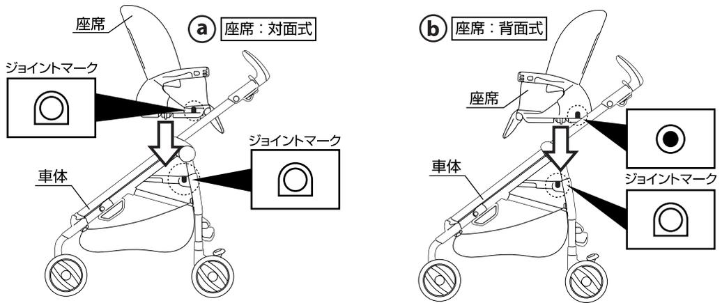
10.(a)座席を対面式で取り付ける場合、(b)座席を背面式で取り付ける場合は、図のように座席のジョイントマークと車体のジョイントマークを合わせて取り付けて下さい。※座席が確実に取り付けられていることを必ず確認して下さい。
