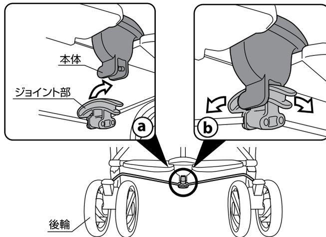
5. 後輪のジョイント部を(a)のように本体に取り付けて下さい。ジョイント部が(b)のように前後に動くことを確認して下さい。
