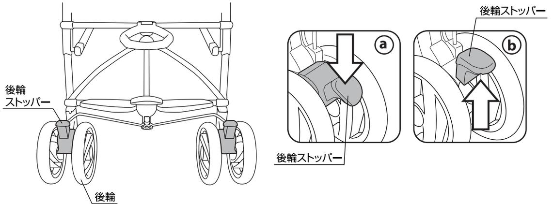
14.(a)後輪ストッパーを下げると後輪がロックします。(b)後輪ストッパーを上げるとロックが解除されます。※お子様を乗り降りさせる場合は必ず後輪ストッパーをロックして下さい。
