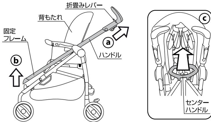
25.(a)両側のハンドルに付いている折畳みレバーを引き、(b)両側の固定フレームを外して下さい。(c)センターハンドルを持ち上げて折り畳んで下さい。※折り畳まれた状態で確実に固定されていることを必ず確認して下さい。
