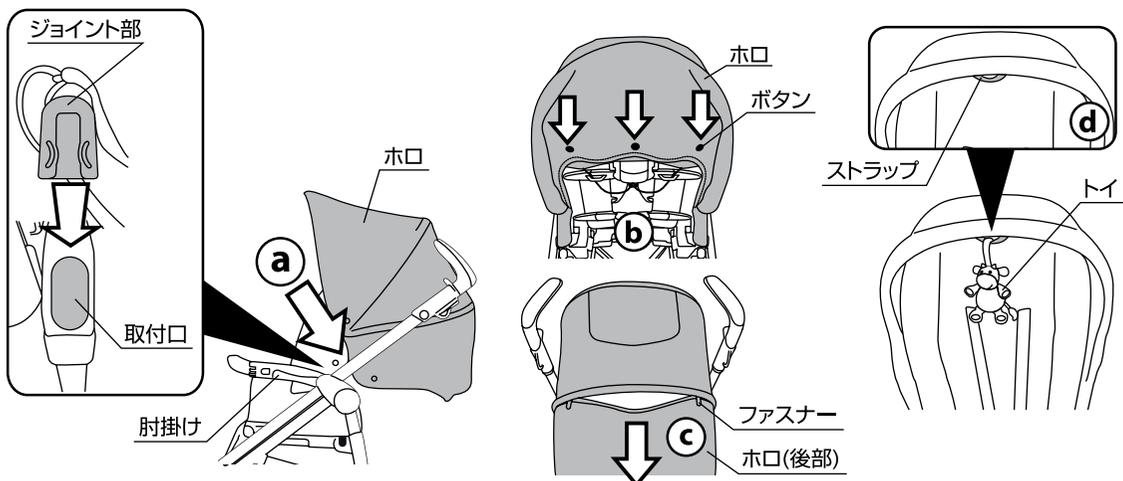
8.(a)ホロを取り付ける場合は、ホロの両側に付いているジョイント部を肘掛けの取付口にスライドして取り付けて下さい。(b)ホロの後部にあるボタンを3箇所背もたれ後部に取り付けて下さい。(c)ホロのファスナーを開いてホロの後部を取り外すことができます。(d)ホロのストラップに別売りの玩具等を引っ掛けることができます。※ホロが確実に取り付けられていることを必ず確認して下さい。
