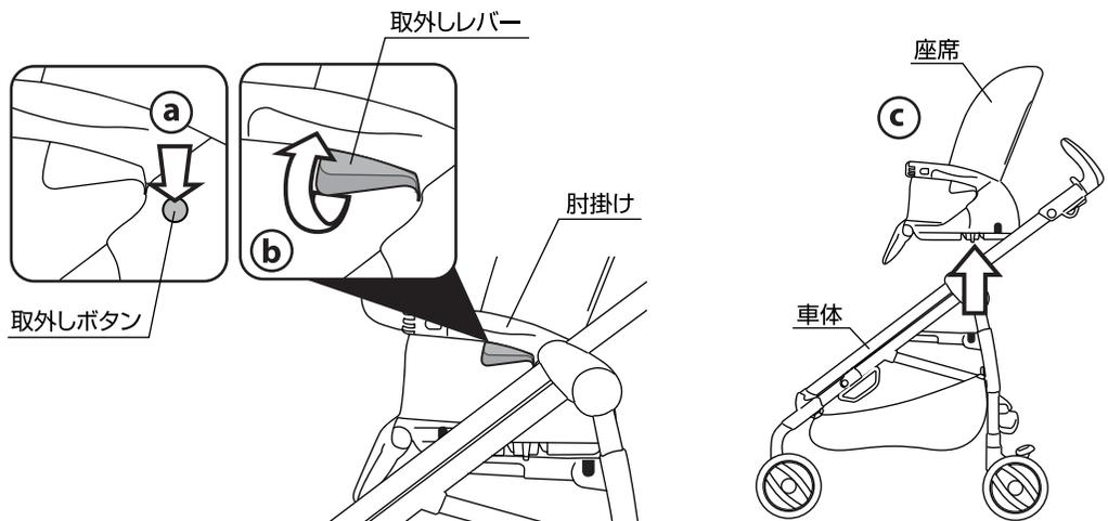
11.座席を取り外す場合は、(a)両側の肘掛けに付いている取外しボタンを押しながら、(b)肘掛けに付いている取外しレバーを握って座席を車体から取り外して下さい。
