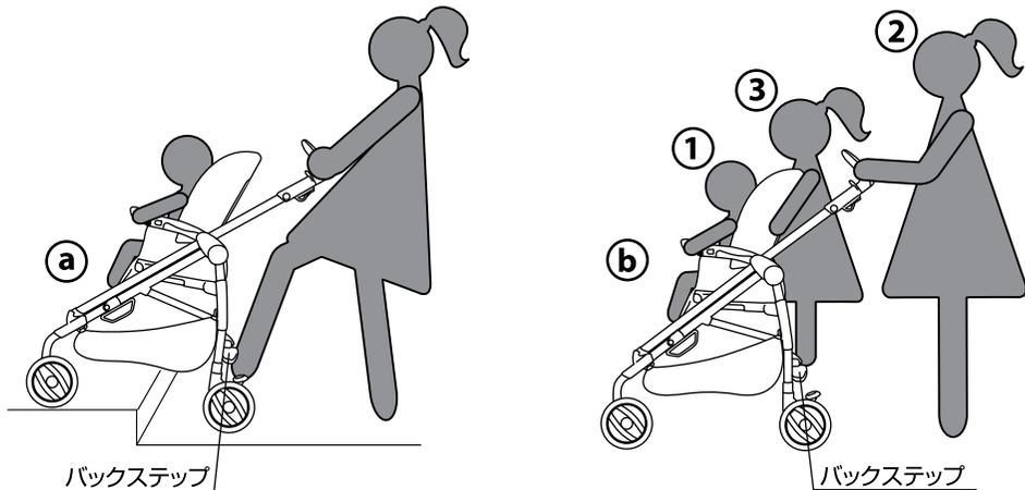
15.(a)段差等乗り越える場合は、ベビーカーのバックステップを軸にしてベビーカーの前側を上げて下さい。
