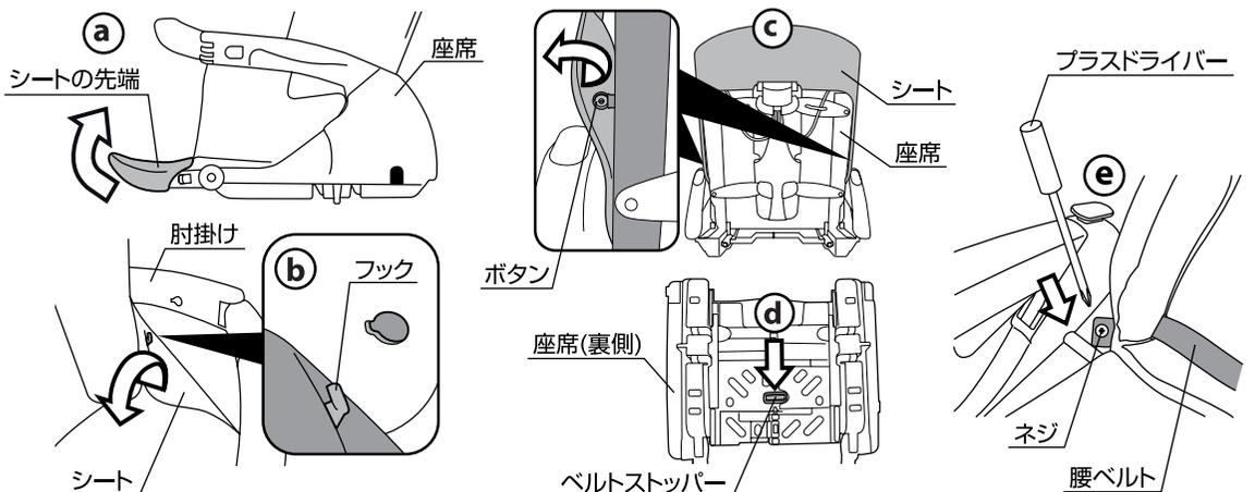
27.(a)シートの先端を座席から外して下さい。(b)シート両側のフックを肘掛けから外して下さい。(計4カ所)(c)シートの両側に付いているボタンを座席から取り外して下さい。(d)股ベルトのベルトストッパーを座面の裏側から抜き取り、(e)腰ベルトの根元に付いているネジをプラスチックドライバーで取り外して下さい。座席からシートを取り外して下さい。
