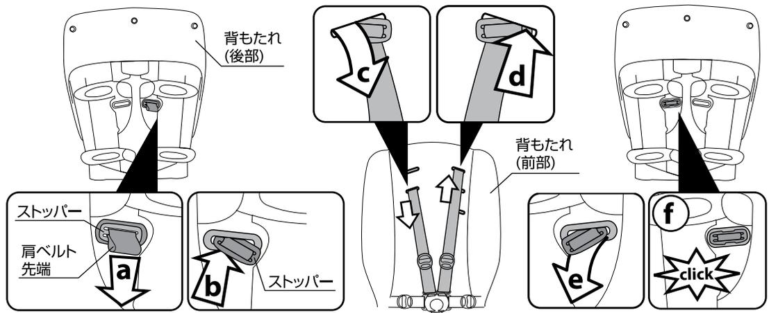
20.肩ベルトの高さを調節する場合は、(a)背もたれ後部から肩ベルトの先端を引っ張りストッパーを外し、(b)ストッパーを肩ベルト穴に通して、(c)背もたれの前部から出して下さい。(d)お好みの高さの肩ベルト穴に通し、(e)背もたれの後部から出して下さい。(f)ストッパーを肩ベルト穴に取り付けて下さい。\*肩ベルトの高さは必ず両側とも同じ高さにして下さい。
