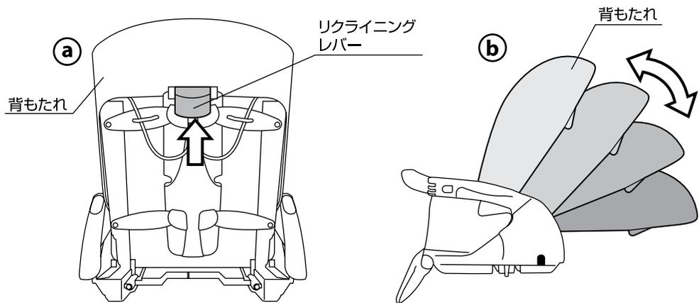
16.(a)座席の後部に付いているリクライニングレバーを上げると、(b)背もたれの高さを調節することができます。(4段階調節)
