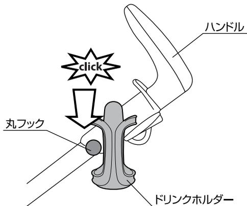
9.ドリンクホルダーを左右のハンドルのどちらかの丸フックに取り付けて下さい。※ドリンクホルダーが確実に取り付けられていることを必ず確認して下さい。
