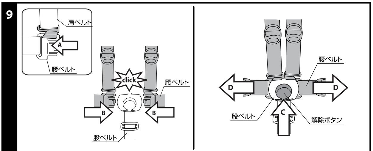
9.シートベルトを取り付ける時は、(A)肩ベルトを腰ベルトに通して下さい。(B)腰ベルトを股ベルトに差し込んで下さい。
