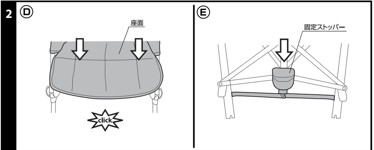
2. (D) 座面の両端を上から押し、本体両側の固定フレームがソケットに取り付けられていることを必ず確認して下さい。(E) 固定ストッパーを下げて下さい。
