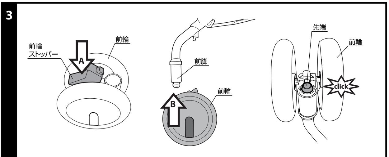
3. (A) 前輪の前輪ストッパーを下げて下さい。(B) 前輪2個を本体両側の前脚に差し込んで取り付けて下さい。(C) 前輪から前脚の先端が出ていることを必ず確認して下さい。
