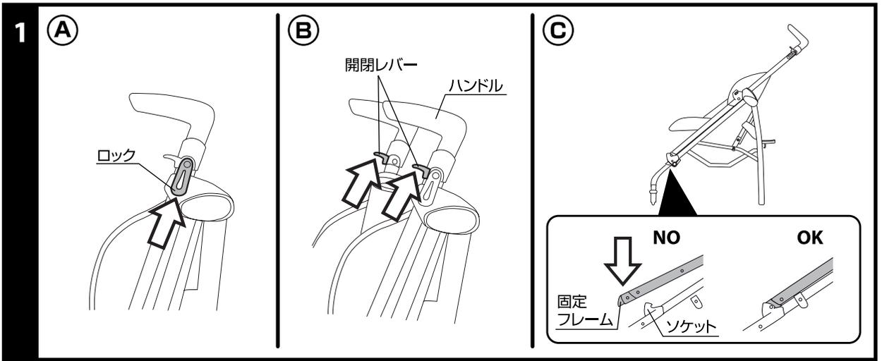
1. (A) 本体のロックを開いて外して下さい。(B) 両側のハンドルに付いている開閉レバーを握りながら本体を持ち上げ、開いて下さい。(C) 本体の両側の固定フレームをソケットに取り付けて下さい。
