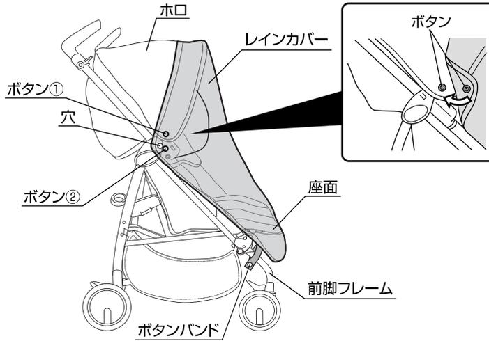
19.レインカバーを取り付ける場合は、本体のホロを開き、レインカバーをホロと座面にかぶせて下さい。レインカバーの両側に付いているボタン①をホロのボタンに固定して下さい。(レインカバーの両側にあるボタン②と穴はpliko miniでは使用しません。)レインカバーの両側に付いているボタンバンドを本体の前脚フレームに巻いて固定して下さい。※レインカバーが確実に取り付けられていることを必ず確認して下さい。
