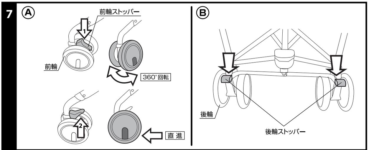
7.(A)(1)前輪ストッパーを下げると前輪が360°回転します。(2)前輪ストッパーを上げると進行方向が固定されます。
