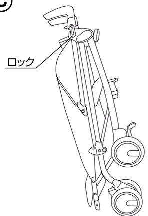
14.本体を折り畳む場合は、(A)両側のハンドルに付いている開閉レバーを握り、(B)ハンドルを少し後に倒し、両側の固定フレームがソケットから外れたことを確認して下さい。片手でハンドルを持ったまま、折畳みレバーを引いて本体を折り畳んで下さい。
