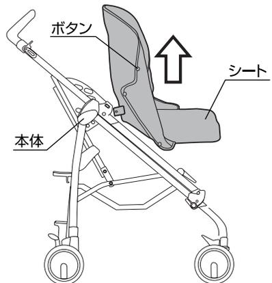
18.⑦シートを座面フレームから取り外して下さい。⑧シートの両側に付いているボタンを本体から外して、シートを取り外して下さい。
