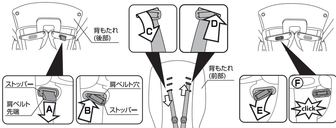
12.肩ベルトの高さを調節する場合は、(A)背もたれ後部から肩ベルトの先端を引っ張りストッパーを取り外し、(B)ストッパーを肩ベルト穴に通して、(C)背もたれの前部から出して下さい。(D)お好みの高さの肩ベルト穴に通し、(E)背もたれの後部から出して下さい。(F)ストッパーを肩ベルト穴に取り付けて下さい。※肩ベルトの高さは必ず両側とも同じ高さにして下さい。
