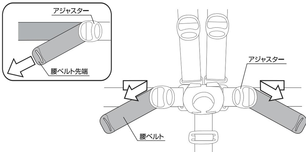
10.腰ベルトの長さを調節する場合は、両側の腰ベルトの先端をアジャスターから引っ張り調節して下さい。
