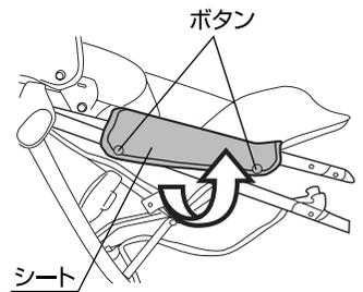
17.④シートの両側に付いているゴムバンドを本体のフックから取り外して下さい。⑤本体両側の固定フレームをソケットから外して下さい。(P6.図14参照)⑥本体フレームの内側に付いているシートのボタン(左右各2個)を取り外して下さい。
