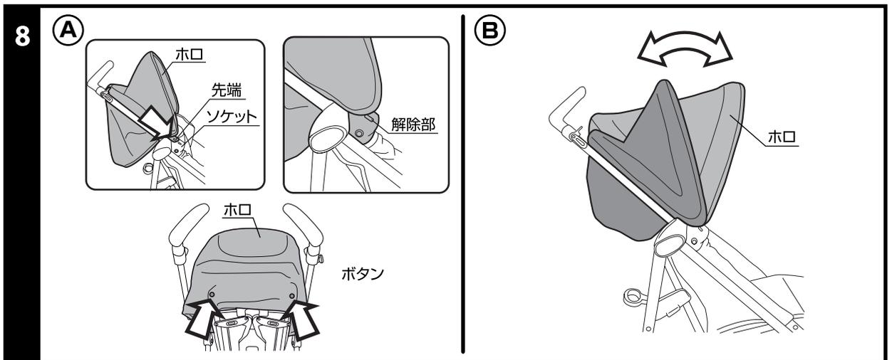
8.(A)ホロの両端を本体のソケットに差し込んで下さい。ホロの後部のボタンを本体の背もたれ後部に取り付けて下さい。(計2箇所)
