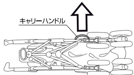
15.(A)折り畳みレバーを持って引いて運ぶことができます。※その場合、両側の前輪ストッパーを上げて前輪の向きを固定して下さい。(P4.図7-A参照)
