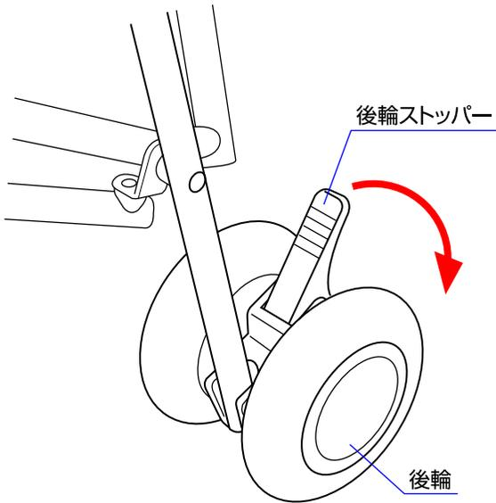
◇両側の後輪ストッパーを下げると後輪がロックされます。解除する時は後輪ストッパーを上げて下さい。
