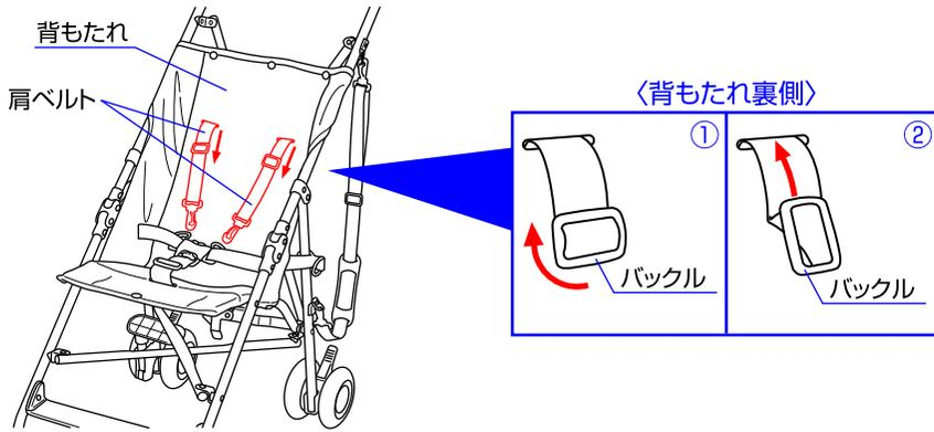
◇ベビーカーの肩ベルトを取り外す場合は、背もたれの裏側から出ている肩ベルトのバックルを縦にして取り外して下さい。(①→②)
