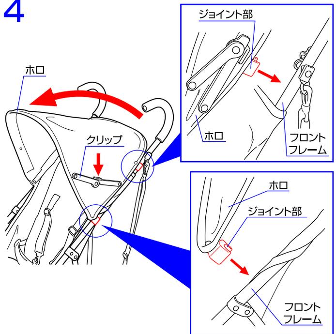
4. 図のようにホロの両側のジョイント部をフロントフレームに取り付けて下さい。ホロを開き、両側のクリップを下げて固定して下さい。
