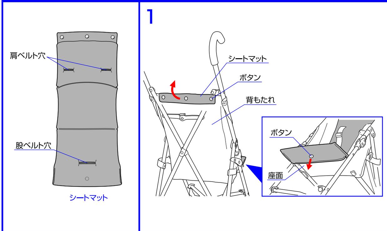
1.シートマットを固定している背もたれ裏側のボタン3個と座面裏側のボタン1個を外して下さい。
