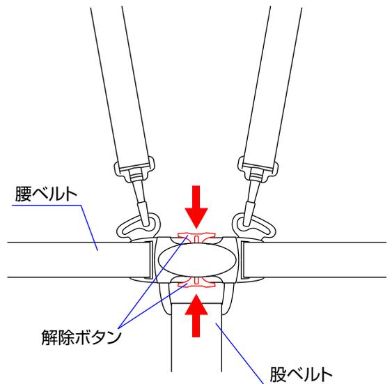
◇腰ベルトを取り外す時は、股ベルトの解除ボタンを押して取り外して下さい。※ベビーカー使用中は必ずシートベルトを締めて下さい。
