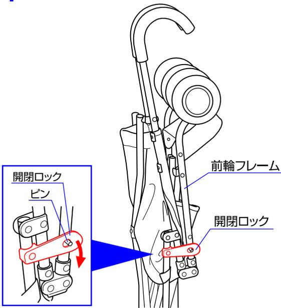
1. 前輪フレームに取り付けられている開閉ロックを外して下さい。
