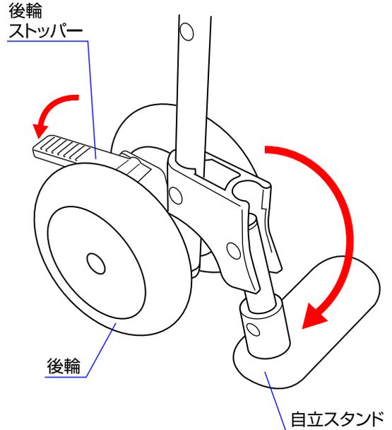
◇ベビーカーを折り畳んだ後に自立させたい時は、両側の後輪ストッパーを下げてから、自立スタンドを出して下さい。※ベビーカーを開いて使用する時は必ず自立スタンドを収納して下さい。
