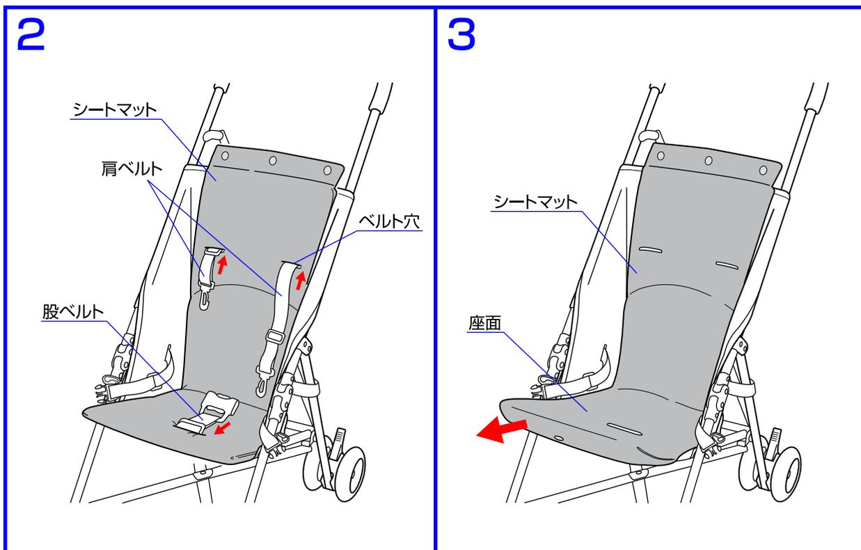
2.肩ベルト、腰ベルト、股ベルトをそれぞれ外し、シートマットの各ベルト穴から肩ベルトと股ベルトを抜き取って下さい。
