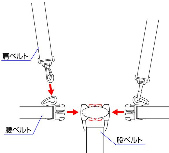
◇取り付ける時は肩ベルトを腰ベルトに取り付け、股ベルトに差し込んで下さい。
