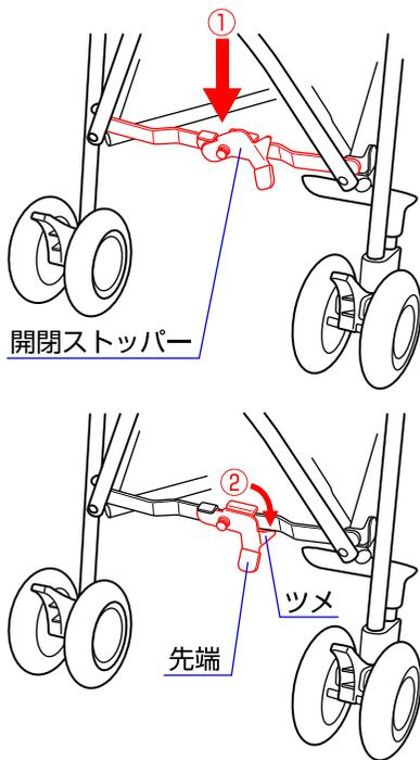
3. ①後輪側に付いている開閉ストッパーを固定するまで足を使って踏み降ろして下さい。
