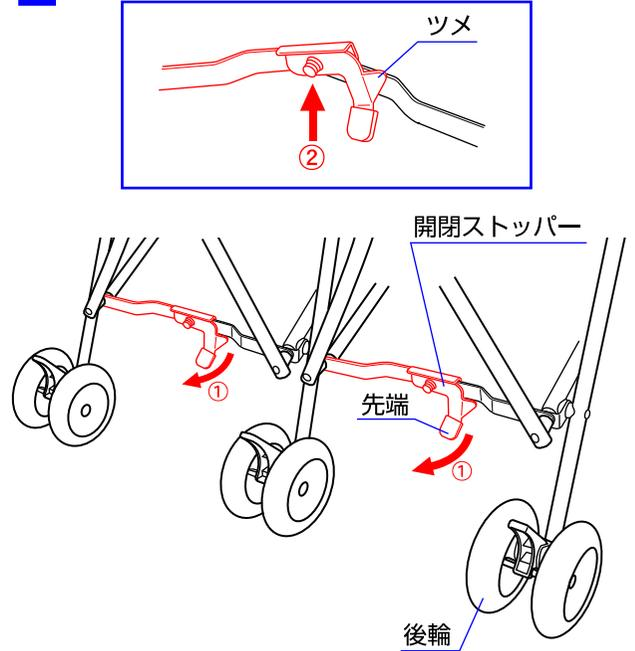
2.①開閉ストッパーの先端を手前に引いてツメを外して下さい。②ツメが外れたのを確認してから開閉ストッパーを上げて下さい。
