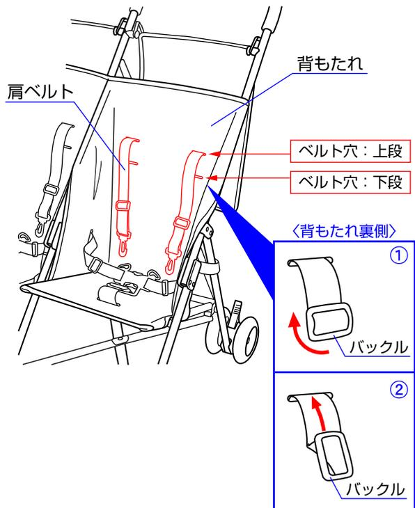
◇肩ベルトは上段、下段の2段階に付け替えることができます。肩ベルトをベルト穴から抜き取る時は、背もたれの裏側から出ている肩ベルトのバックルを縦にしてベルト穴から抜き取って下さい。(①→②)
