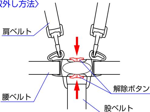
◇肩ベルトを腰ベルトに取り付け、股ベルトに差し込んで下さい。腰ベルトを取り外す時は股ベルトの上下に付いている解除ボタンを押して下さい。
