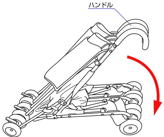
3.本体の各背もたれの後部に付いている安全装置を持ち上げ、ハンドルを前方に倒して折り畳んで下さい。(安全装置は両側の背もたれ後部に1個ずつ付いています。)
