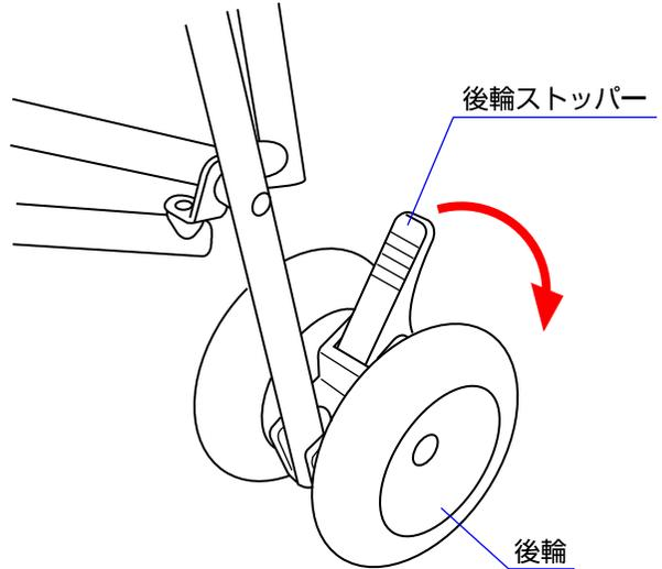
◇後輪のストッパーを足で下げると、後輪がロックされます。解除する時はストッパーを上げて下さい。
