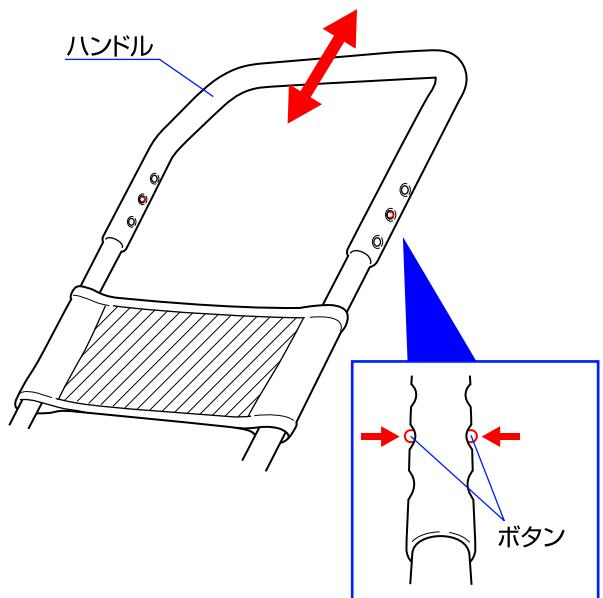
◇ハンドルの両側にあるボタンを押してハンドルの高さを調節して下さい。※必ずボタンが出ていることを確認して下さい。
