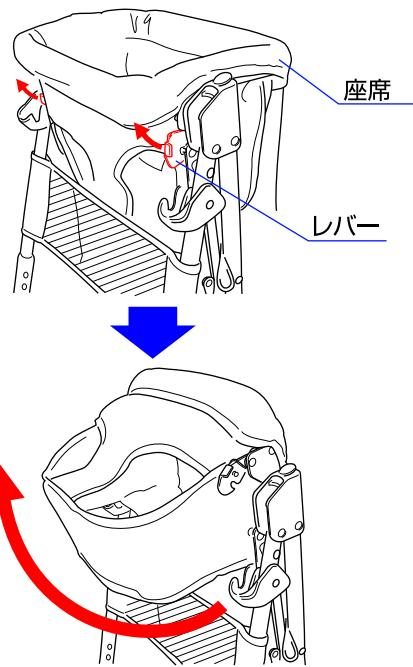
◇座席を折り畳む時は座席両側のレバーを矢印方向に上げて座席を回して折り畳んで下さい。
