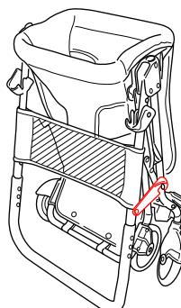
1.タイヤカバーを本体から取り外し、前輪と後輪を留めているテープバンドを外して下さい。
