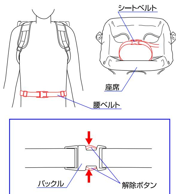
◇キャリーカーの座席にお子様を乗せる場合は必ずシートベルトを締め、リュックとして使用する場合は必ず腰ベルトを使用して下さい。バックルを取り外す時は解除ボタンを押して取り外して下さい。
