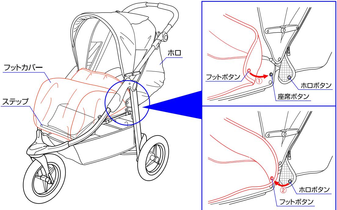
◇フットカバーを座席のステップからかぶせて下さい。①両側のフットボタンを座席ボタンに取り付けて下さい。
