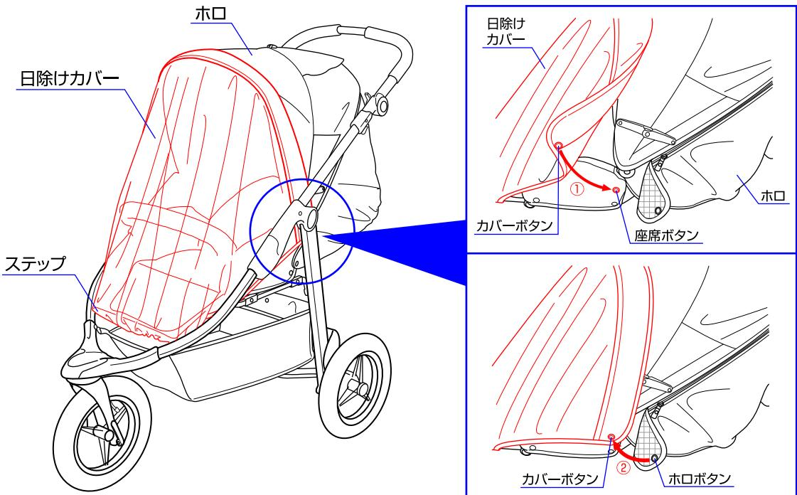
◇日除けカバーを図のようにホロとステップにかぶせ、①日除けカバーのカバー ボタンを座席の両側の座席ボタンに取り付けて下さい。②両側のカバー ボタンの上にホロ ボタンを取り付けて下さい。
