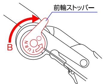
△ハンドルに付いている前輪ストッパーをAの方向へ回すと前輪が360°回転します。前輪ストッパーをBの方向へ回すと前輪の向きが固定されます。※前輪ストッパーは最後まで確実に回して下さい。
