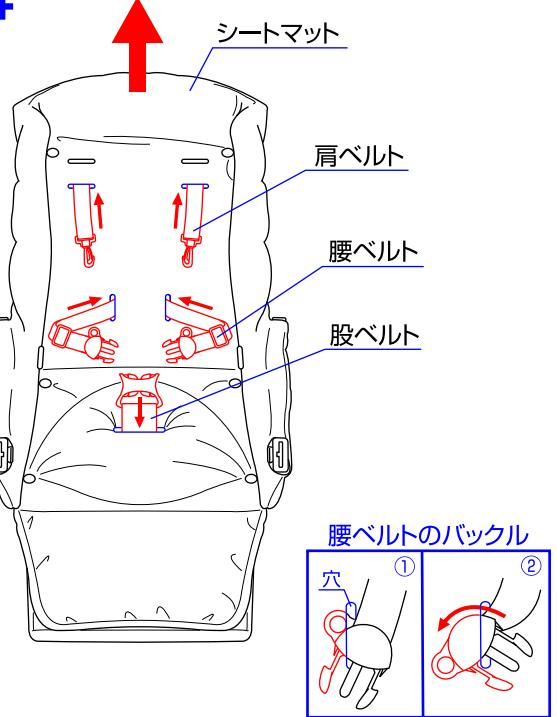
3. シートマットのボタン(計6個)を座席から取り外して下さい。Dリングをシートマットから抜き取って下さい。
