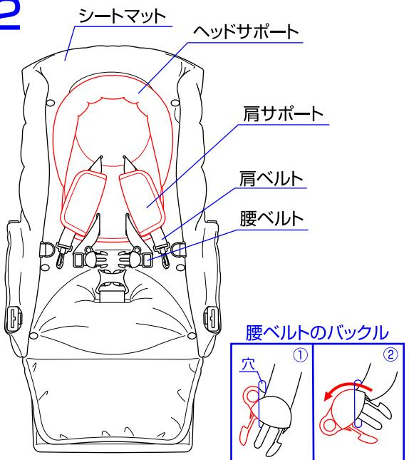
1. シートマットの両側に付いているボタン(計4個)を座席から外し、シートマットの後部から出ているリクライニングレバーをカバーの内側に入れて下さい。
