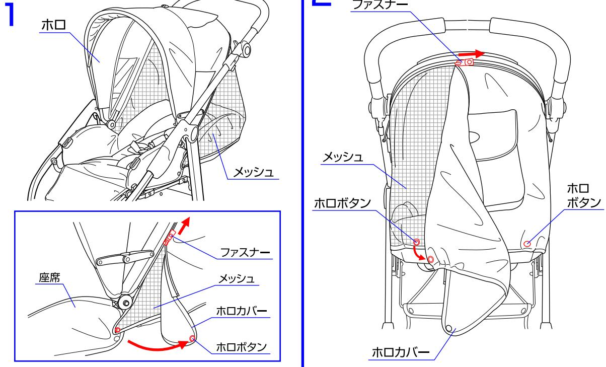
1. メッシュを残したままホロボタンを取り外し、ファスナーで開いて下さい。反対側のホロボタンも同じように外して下さい。
