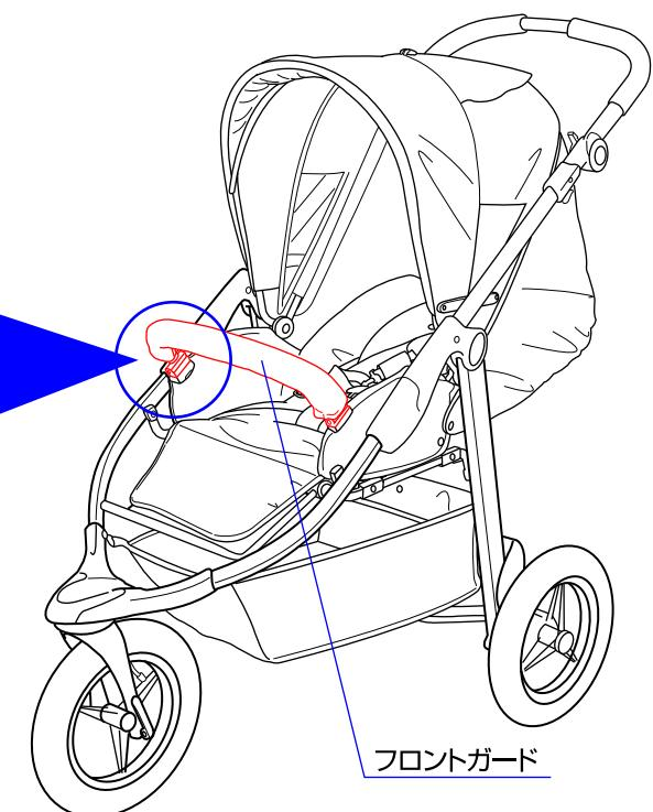
10. フロントガードの両側の先端を肘掛けのガード取付口に差し込んで下さい。
