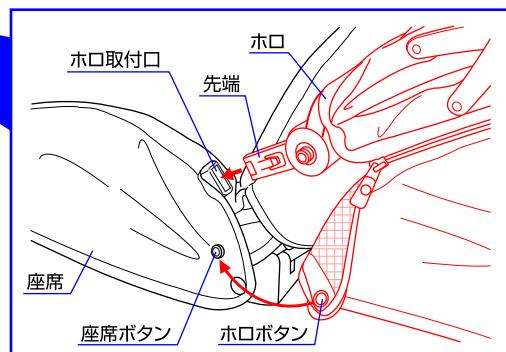
9. ホロの両側の先端を座席のホロ取付口に差し込んで下さい。ホロの両側と後部に付いているホロボタンを座席ボタンに取り付けて下さい。(計4箇所) ホロを開き、両側に付いているクリップを下げる固定して下さい。
