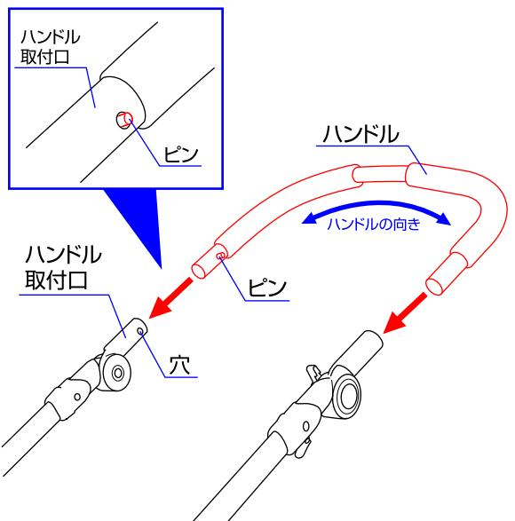
6.両側のハンドル取付口の回転ボタンを押しながら、取付口を上に回転させて下さい。※両側のハンドル取付口は同じ角度にして下さい。
