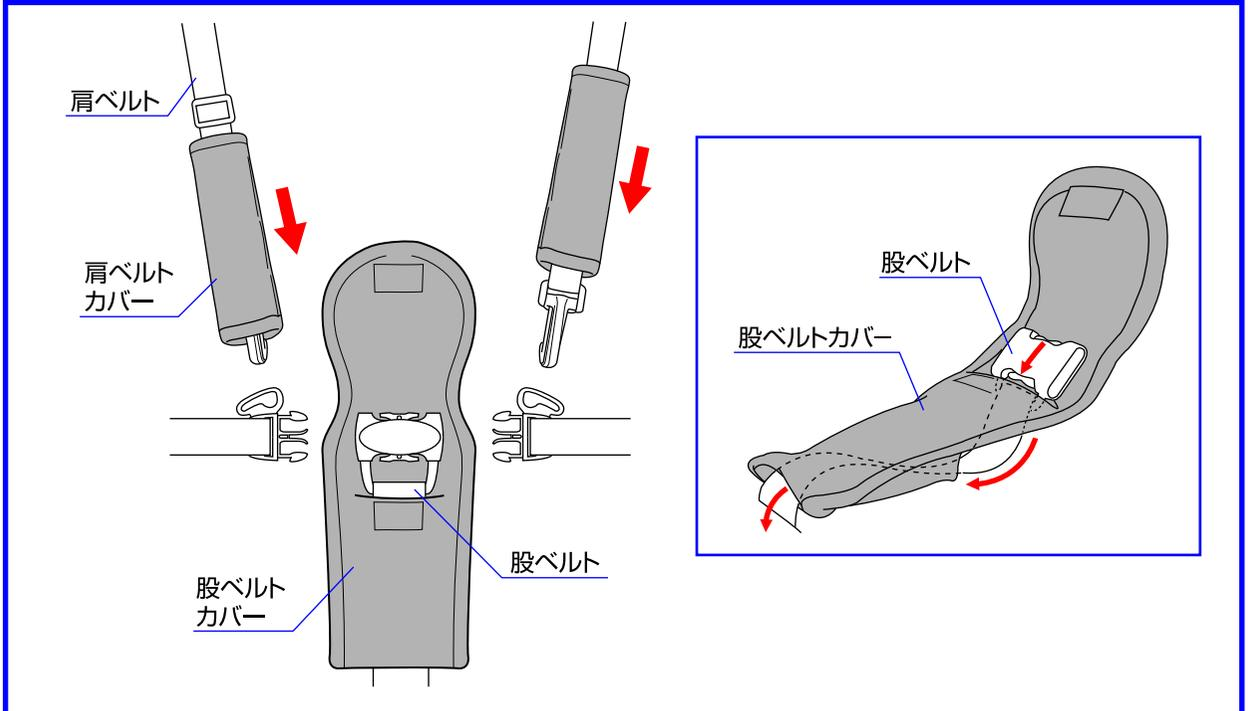
◇シートベルトを全て外し、肩ベルトから肩ベルトカバーを抜き取って下さい。股ベルトカバーは図のように股ベルトから抜き取って下さい。
