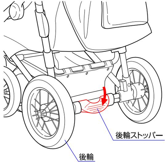
◇後輪ストッパーを下げると後輪がロックされます。解除する時は後輪ストッパーを上げて下さい。
