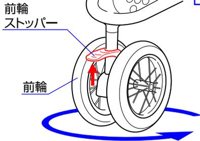
◇前輪ストッパーを下げると前輪の向きが固定されます。前輪ストッパーを上げると前輪が360°回転します。
