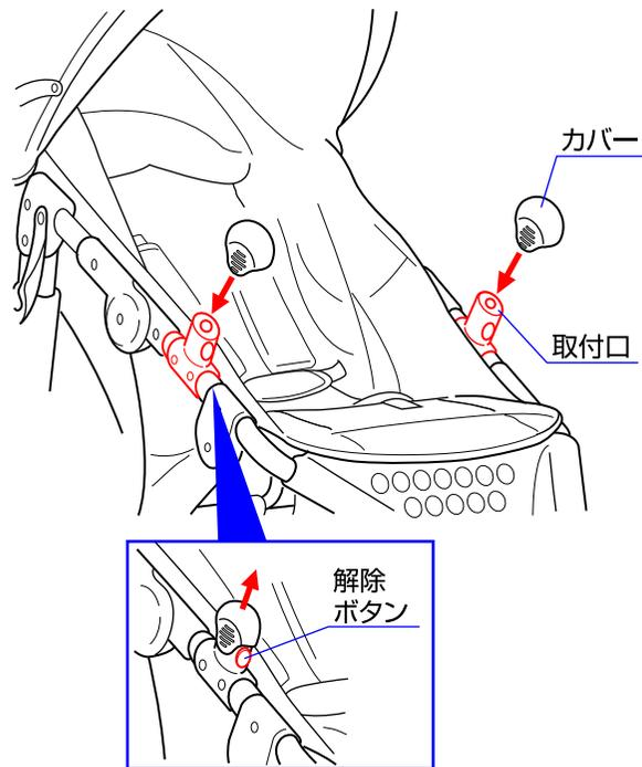
◇フロントガードを取り外して使用する場合は、カバーを両側の取付口に差し込んで下さい。取り外す時は解除ボタンを押して下さい。
