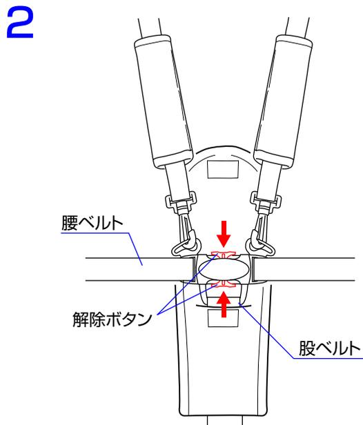
2.腰ベルトを取り外す時は解除ボタンを押して股ベルトから取り外して下さい。
