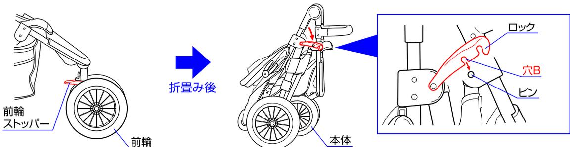
◇本体を折り畳む前に前輪ストッパーの向きを確認して下さい。収納する時はロック先端側の穴Aをピンにかけて下さい。自立させる時は穴Bをピンにかけて下さい。穴Aでも自立させることが可能です。
