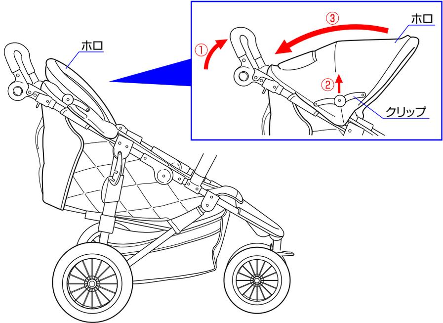
1. ①最初にハンドルを最も高い位置にして下さい。(P5「ハンドルの高さ調節」を参照して下さい。) ②ホロのクリップを上げ、③ホロを折り畳んで下さい。
