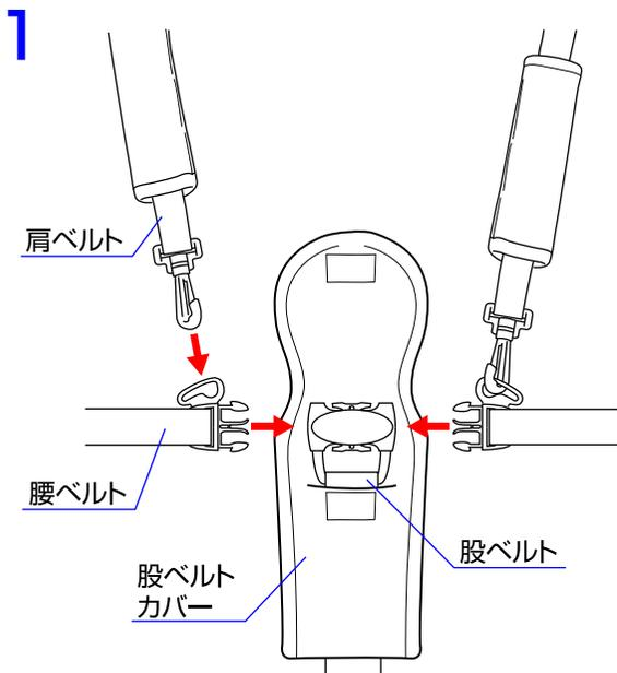
1.シートベルトを取り付ける時は股ベルトカバーを開け、肩ベルトを腰ベルトに取り付け、股ベルトに差し込んで下さい。※ベビーカーを使用する時は必ずシートベルトを締めて下さい。
