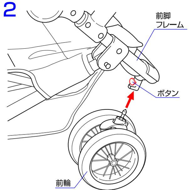
2. 前脚フレームに付いているボタンを押しながら、前輪を差し込んで下さい。\*取り外す時はボタンを押して前輪を抜き取って下さい。\*前輪が確実に固定されていることを必ず確認して下さい。
