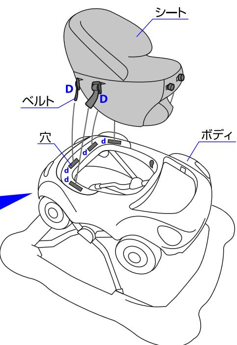
3. シートのベルトDをボディのd穴に差し込んで下さい。フックを出して固定して下さい。(①～③)※4力所行って下さい。
