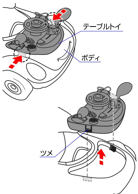
2. テーブルトイのツメをボディのテーブル面の穴に取り付けて下さい。
