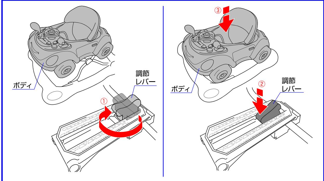
◇ボディの裏側にある調節レバーを①回転させて、②調節レバーを押し込んで下さい。③ボディを持ちながらゆっくりとボディを下げる場合はボディを持って上げて下さい。(3段階調節)
