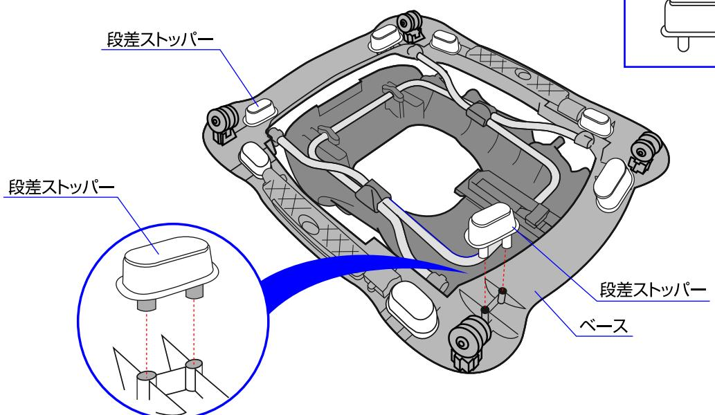
7. 段差ストッパーをベースの裏側に差し込んで取り付けて下さい。(計8個)
