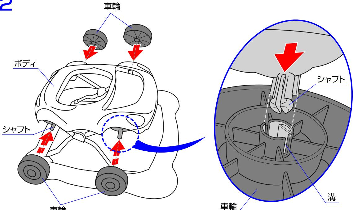
2. ボディのシャフトに車輪の溝を合わせて差し込んで取り付けて下さい。※車輪は回転しません。
