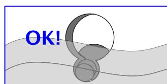
4. ①最初に丸フックE(2力所)をe穴に差し込んで下さい。②丸フックEを横にスライドしながら、丸フックFを差し込んで下さい。③丸フックE、Fを下げる固定して下さい。
