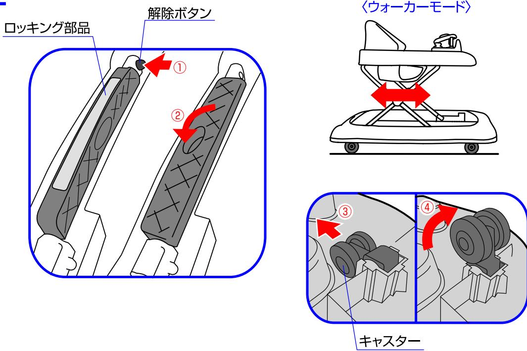
2. ロッキングモードからウォーカーモードに戻す場合は、①ロッキング部品の解除ボタンを押して、②ロッキング部品を収納して下さい。(2箇所)③キャスターを引っ張り、④キャスターを起こして下さい。(4箇所)
