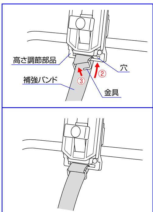
5. ①補強バンドをシートの裏側のバンドに通して下さい。②補強バンドを高さ調節部品の穴に通して、③金具に通して取り付けて下さい。
