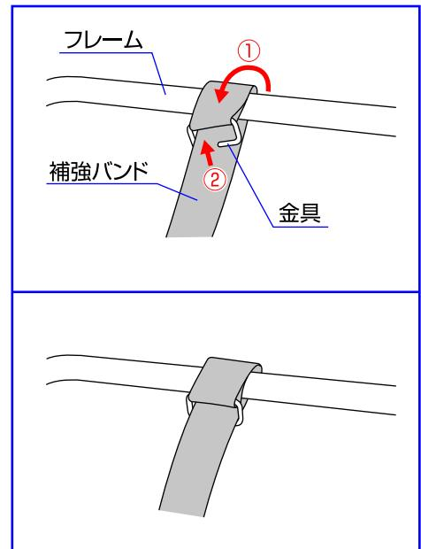
6. 補強バンドの反対側は①フレームに巻いて、②金具に通して取り付けて下さい。
