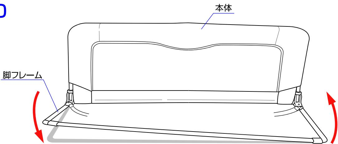
10.組立後に本体が歪んで片側の脚フレームが浮いてしまう場合は、歪みと反対側にひねって直して下さい。
