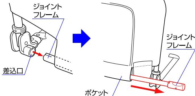
7. 差込口からジョイントフレームを外し、ポケットからジョイントフレームを抜き取って下さい。
