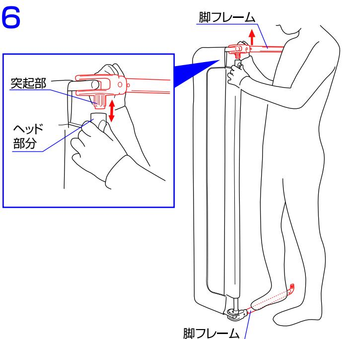
6.足で下の脚フレームを押さえながら、ヘッド部分を突起部から取り外して下さい。※取り外しにくい場合は脚フレームを押し上げながら取り外して下さい。
