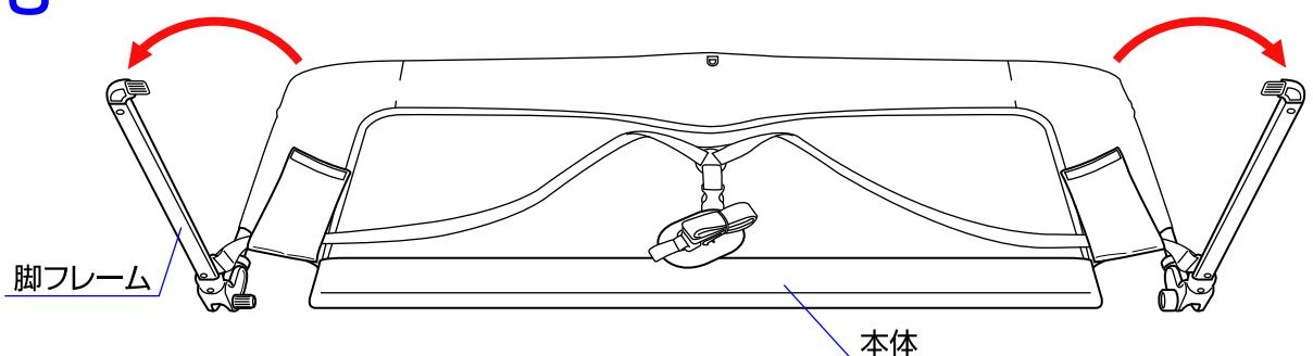
3.本体両側の脚フレームを起こして固定して下さい。※脚フレームが確実に固定されていることを必ず確認して下さい。
