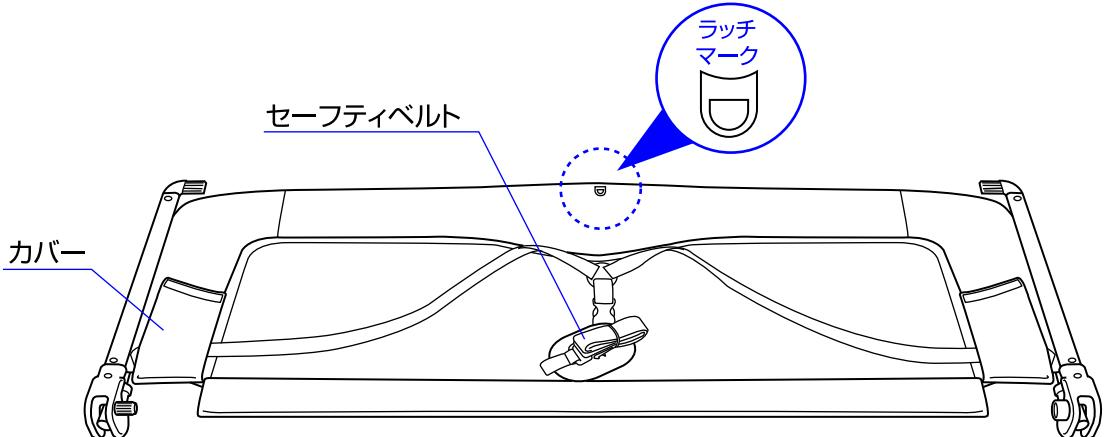
2.ラッチマークの部分が確実に固定されていることを確認して下さい。この時、絡まるのを防ぐためにセーフティベルトを図の位置に置き、左右のカバーをめくって下さい。
