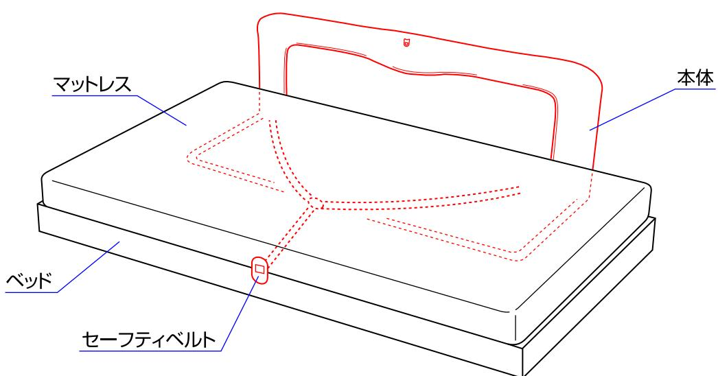
1.図のように本体をマットレスとベッドの間にはさみ、反対側からセーフティベルトを出して下さい。
