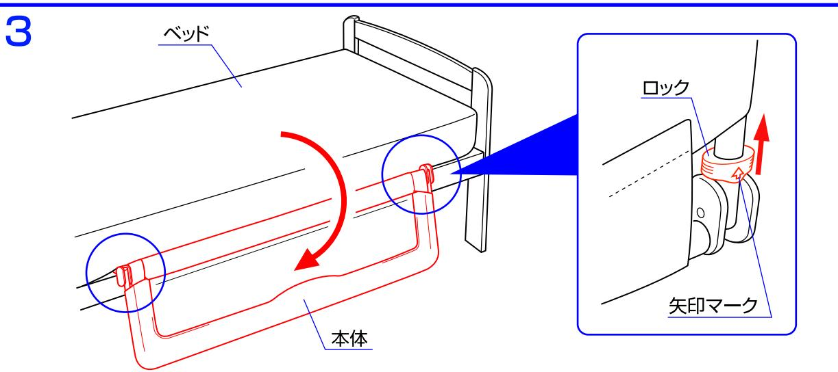
3. ベッドガードを使用しない時は、本体両側の下側に付いているロックを矢印マークの方向に外し、本体を手前に倒して下さい。
