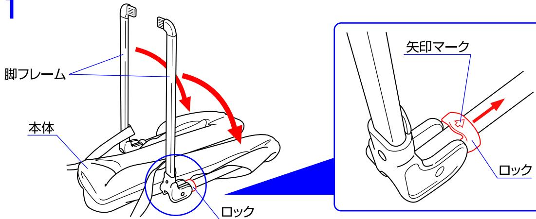
11.本体両側に付いている脚フレームのロックを矢印マークの方向に外して、脚を折り畳んで下さい。
