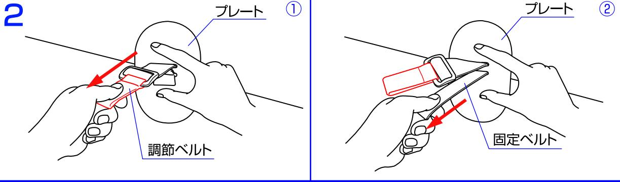
2. ①セーフティベルトのプレートを押さえながら、調節ベルトを引っ張り、長さを調節して下さい。
