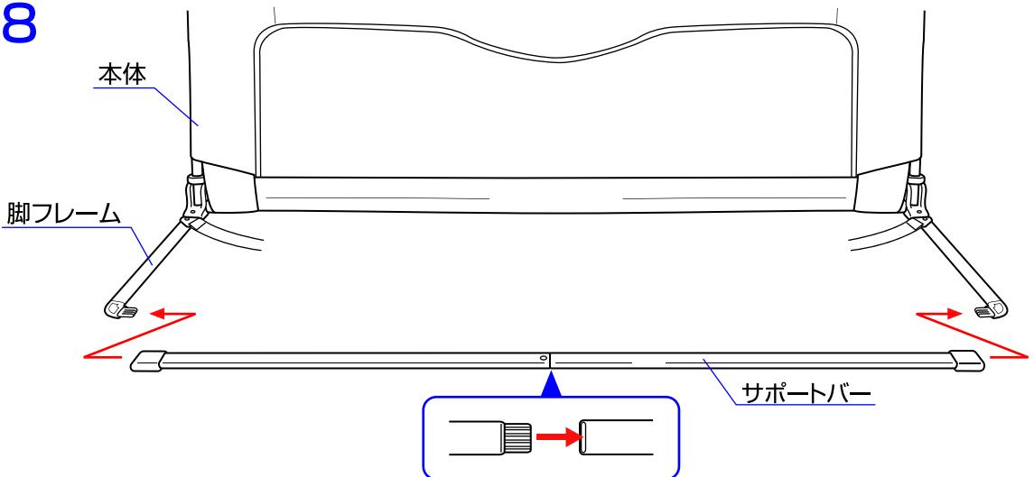
8.サポートバー同士を組み合わせて、本体の脚フレームの先端に差し込んで下さい。
