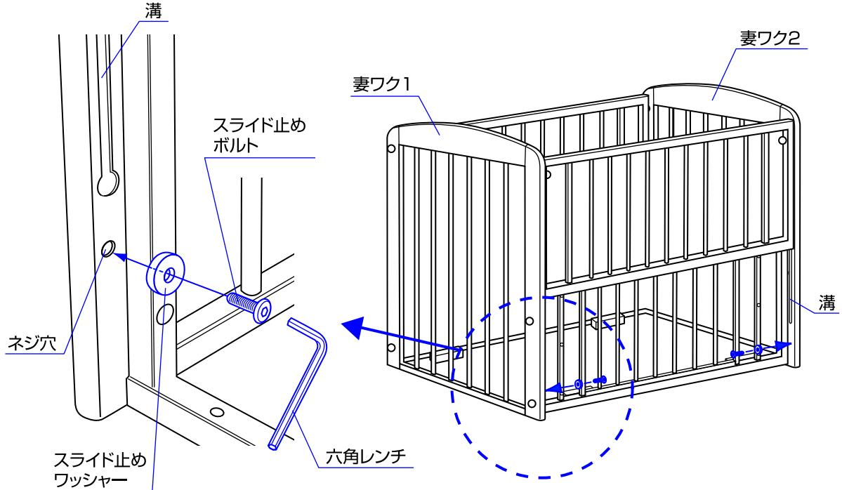
4.妻ワク1と2の溝の下のネジ穴にスライド止めワッシャーをスライド止めボルトで固定して下さい。
