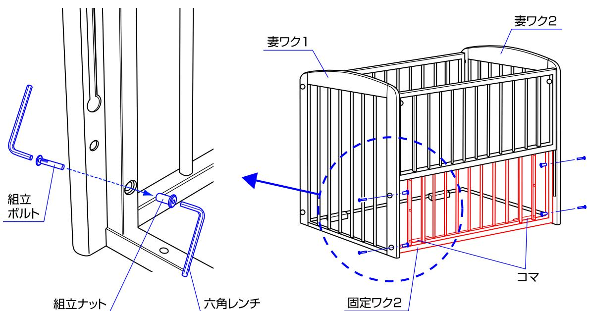
3.妻ワク1と2に固定ワク2を組立ボルトと組立ナットで固定して下さい。
