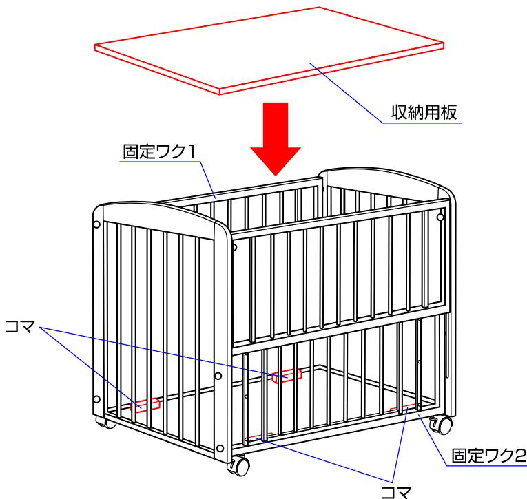
6.収納用板を固定ワク1と2の下側に付いているコマに載せて下さい。
