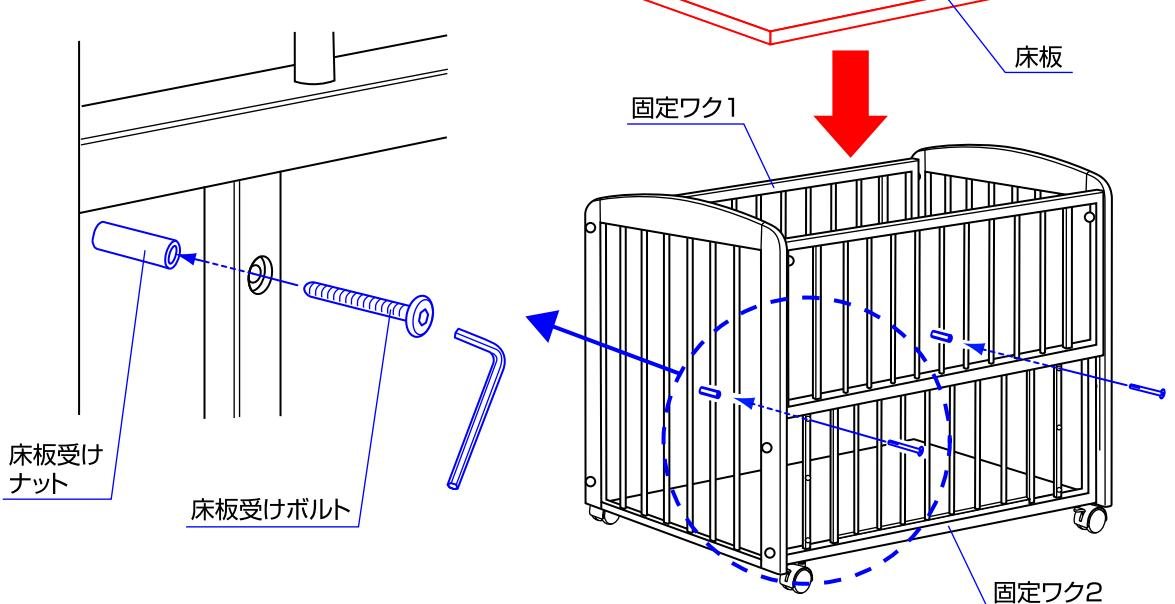
7.床板受けボルトと床板受けナットを取り付けて下さい。 (3段階調節)
