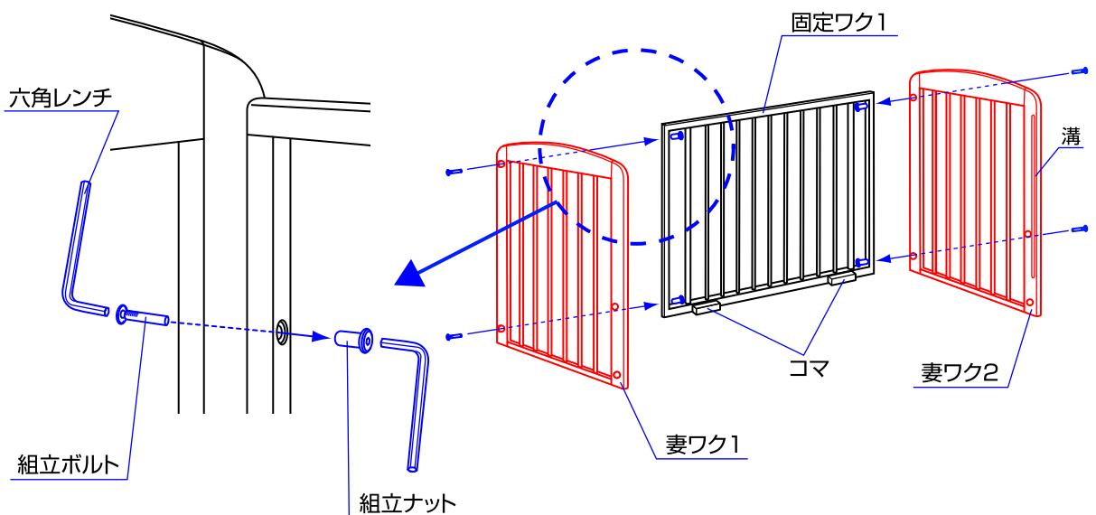
1.妻ワク1と2を固定ワク1に組立ボルトと組立ナットで固定して下さい。
