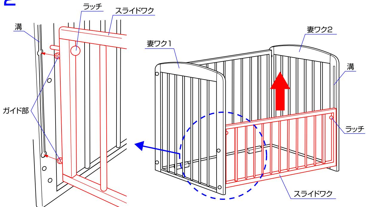
2.スライドワクのガイド部を図のように妻ワク1と2の溝の丸い部分に差し込み、スライドワクを上にスライドさせて下さい。
