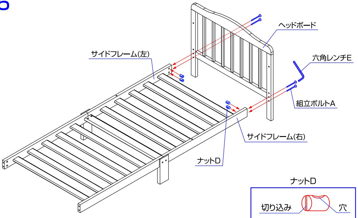
5.サイドフレーム(右)(左)にナットD(各2個)を差し込み、ヘッドボードの外側から組立ボルトA(4個)を六角レンチEで締め付けて下さい。(ナットDは切り込みが手前に来て、穴はボルト方向に合わせて差し込んで下さい。)
