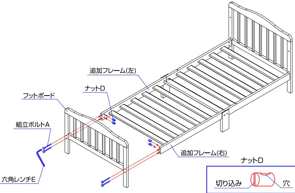
6.追加フレーム(右)(左)にナットD(各2個)を差し込み、フットボードの外側から組立ボルトA(4個)で締めて取り付けて下さい。(ナットDは切り込みが手前に来て、穴はボルト方向に合わせて差し込んで下さい。)
