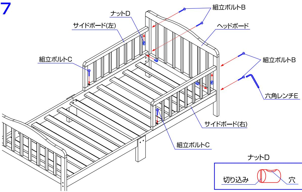
7.サイドボード(右)(左)にナットD(各2個)を差し込み、ヘッドボードの外側から組立ボルトB(4個)で締めて取り付けて下さい。(ナットDは切り込みが手前に来て、穴はボルト方向に合わせて差し込んで下さい。)
