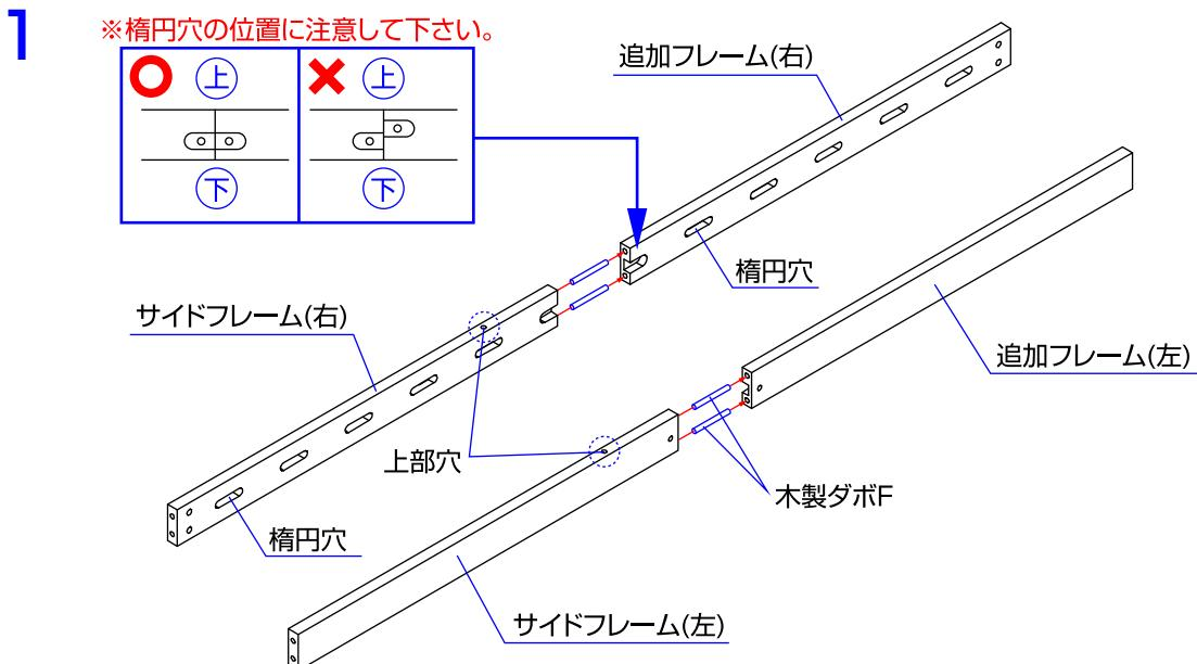
1. サイドフレーム(右)(左)に木製ダボF(各2個)を差し込み、追加フレーム(右)(左)を差し込んで下さい。
