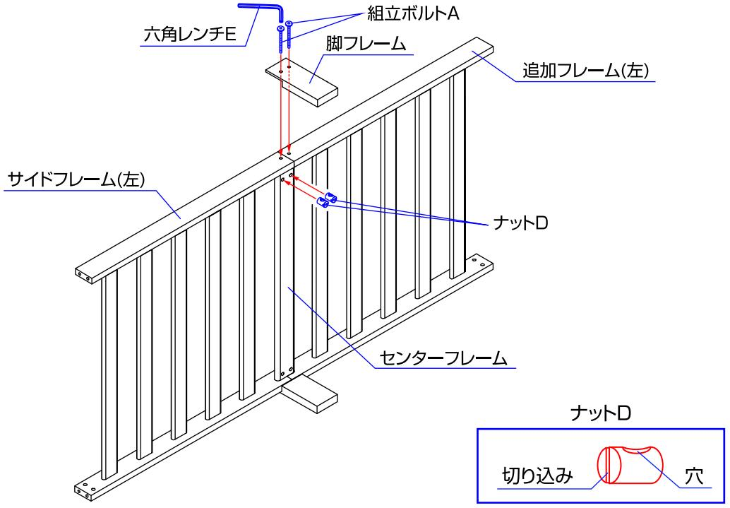
4.図3で組立てたサイドフレーム(左)と追加フレーム(左)に脚フレームを合わせて下さい。
