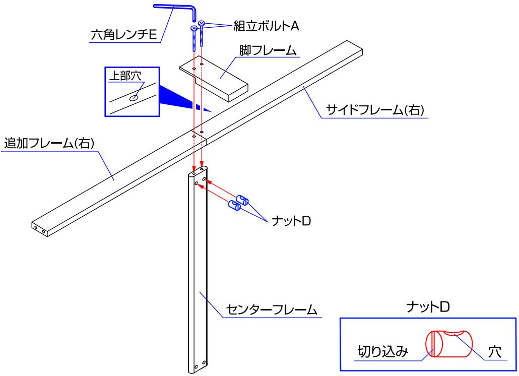
2. 図1で組立てたサイドフレーム(右)と追加フレーム(右)にセンターフレームを差し込み、脚フレームを合わせて下さい。
