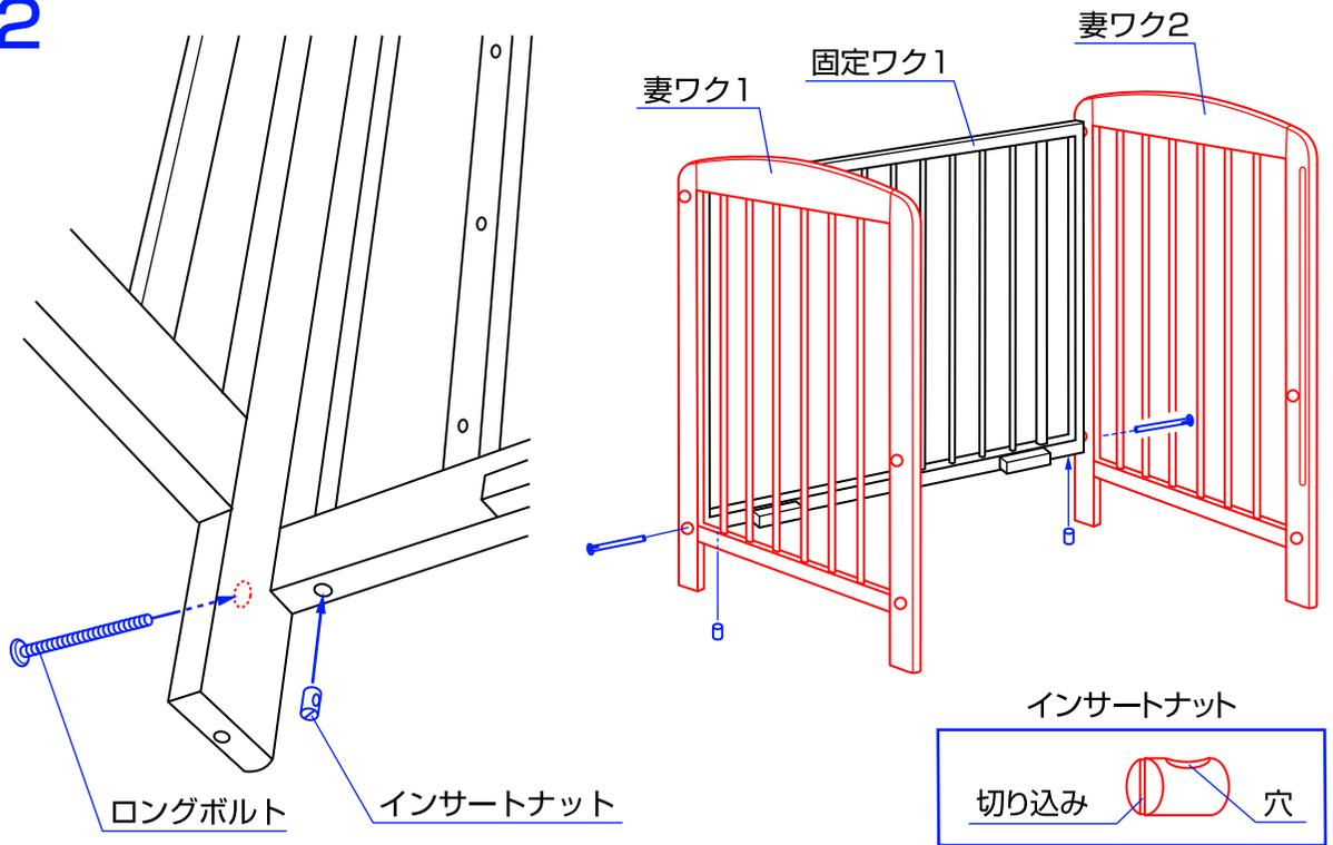
2.固定ワク1の裏側からインサートナットを差し込み、妻ワク1、2の方向からロングボルトで固定して下さい。
