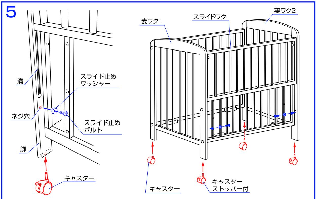
5. 妻ワク1と2の溝の下のネジ穴にスライド止めワッシャーをスライド止めボルトで固定して下さい。妻ワク1と2の脚の裏側にキャスターを図のように差し込んで下さい。キャスターはストッパーのある方をスライドワク側に差し込んで下さい。※ベッドの移動時以外は必ずキャスターのストッパーを下げてロックして下さい。
