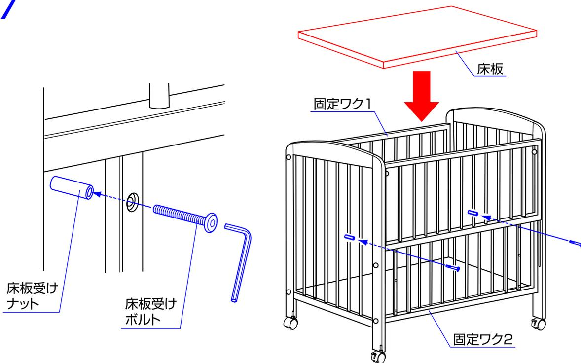
7. 床板受けボルトと床板受けナットを固定ワク1、2に取り付けて下さい。(3段階調節)
