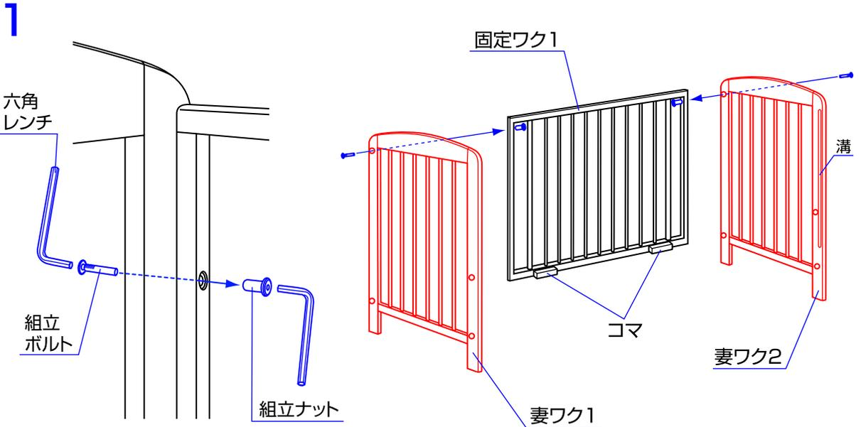
1. 妻ワク1と2を固定ワク1に組立ボルトと組立ナットで固定して下さい。ボルトとナットは六角レンチで締め付けて下さい。(組立ボルトと組立ナットは先に外して下さい。)
