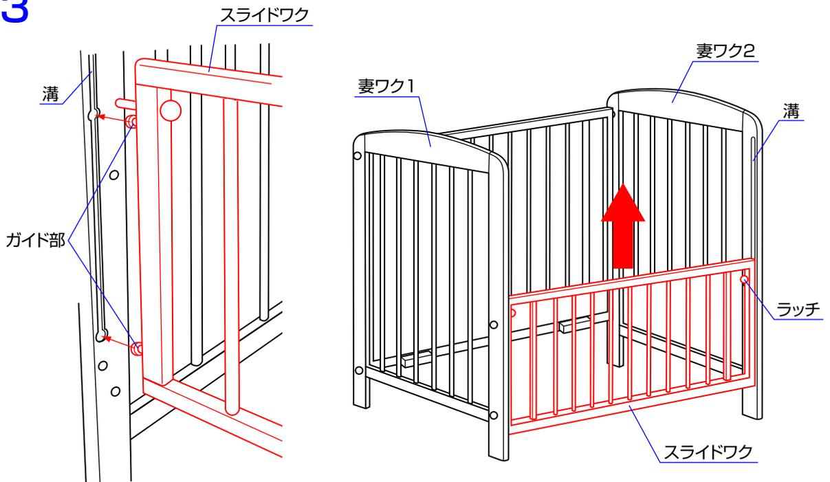
3.スライドワクのガイド部を図のように妻ワク1と2の溝の丸い部分に差し込み、スライドワクを上へスライドさせて下さい。
