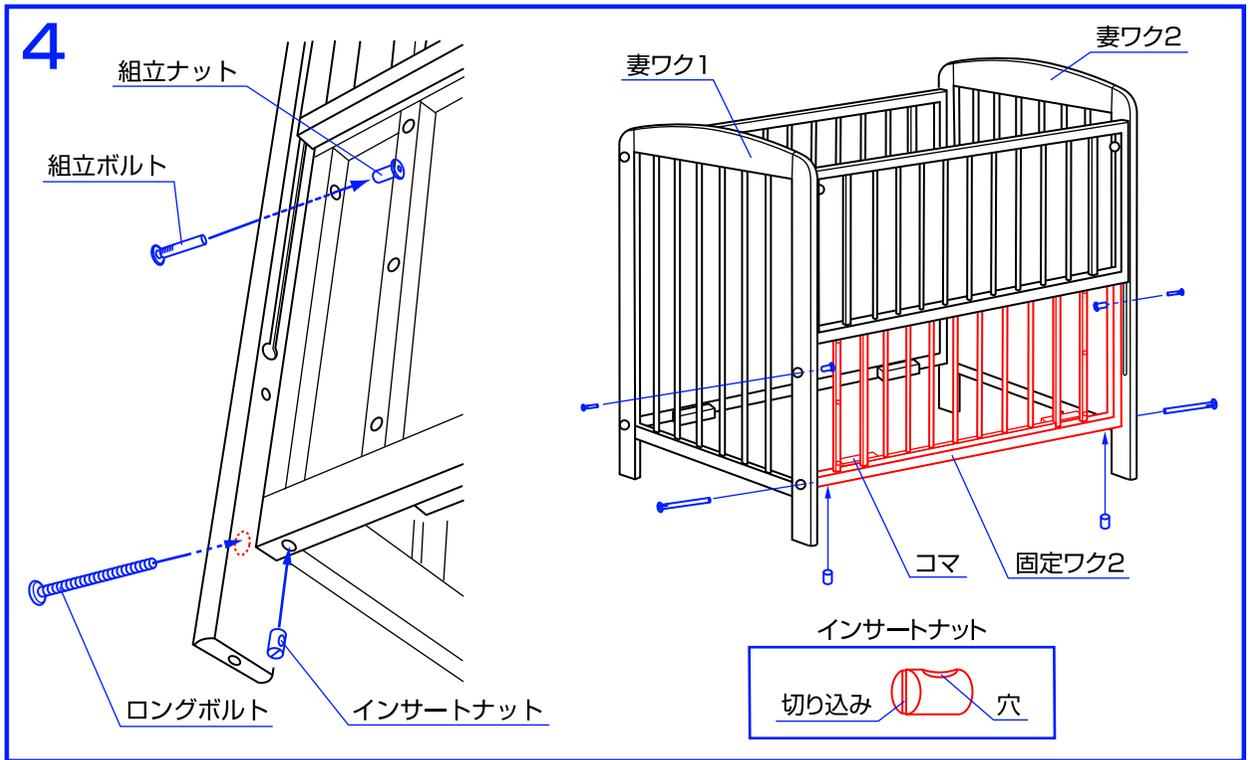
4. 妻ワク1と2と固定ワク2の上側の穴を組立ボルトと組立ナットで固定して下さい。
