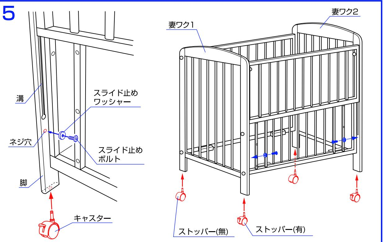
5. 妻ワク1と2の溝の下のネジ穴にスライド止めワッシャーをスライド止めボルトで固定して下さい。妻ワク1と2の脚の裏側にキャスターを図のように差し込んで下さい。キャスターはストップバーのある方をスライドワク側に差し込んで下さい。※ベッドの移動時以外は必ずキャスターのストップバーを下げるロックして下さい。
