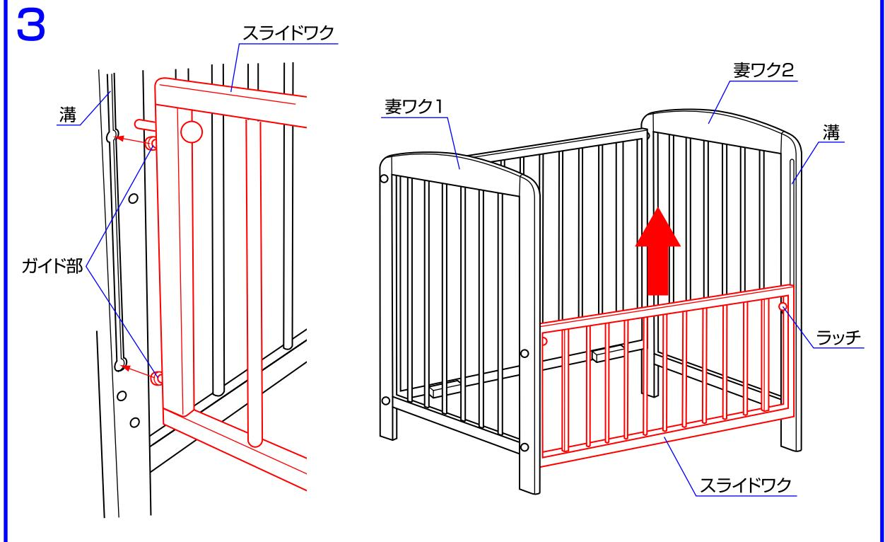
3.スライドワクのガイド部を図のように妻ワク1と2の溝の丸い部分に差し込み、スライドワクを上にスライドさせて下さい。※スライドワクを開閉する時に手足等をはさむ危険性がありますから十分に注意してご使用下さい。また、保護者の方以外は絶対に操作しないで下さい。
