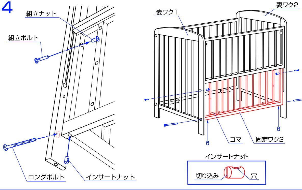
4. 妻ワク1と2と固定ワク2の上側の穴を組立ボルトと組立ナットで固定して下さい。
