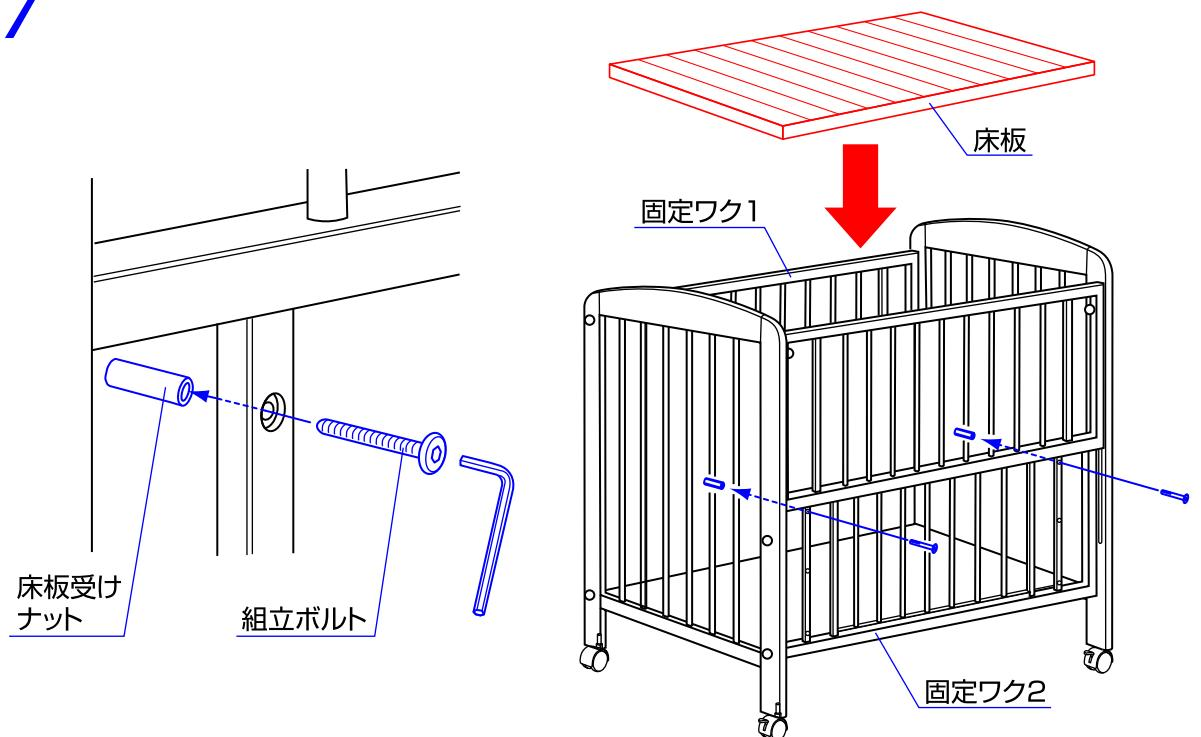
7. 組立ボルトと床板受けナットを固定ワク1、2に取り付けて下さい。 (3段階調節)
