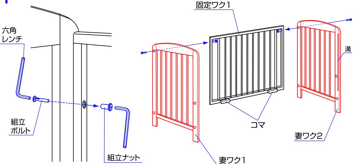
1.妻ワク1と2を固定ワク1に組立ボルトと組立ナットで固定して下さい。ボルトとナットは六角レンチで締め付けて下さい。（組立ボルトと組立ナットは先に外して下さい。）
