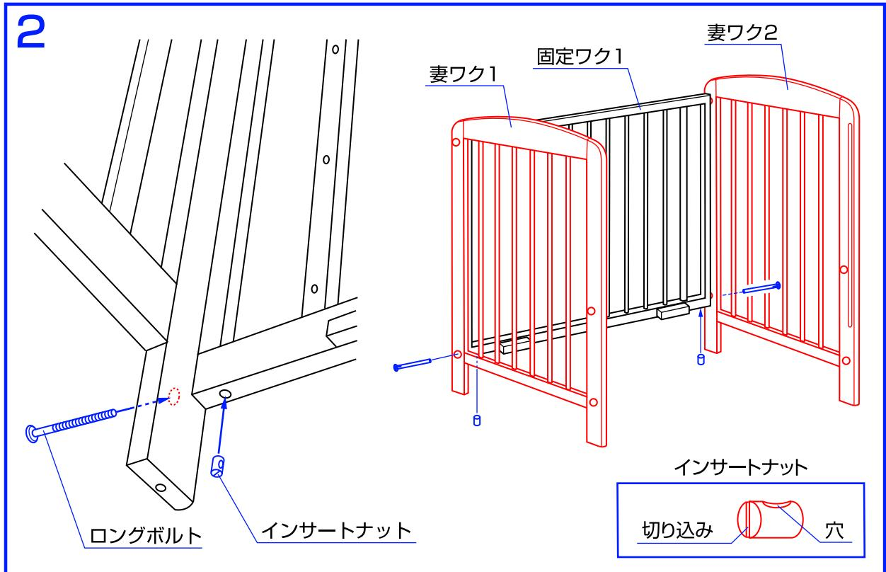
2.固定ワク1の裏側からインサートナットを差し込み、妻ワク1、2の方向からロングボルトで固定して下さい。※インサートナットは切り込みを下に向けて穴をボルト方向へ向けて下さい。
