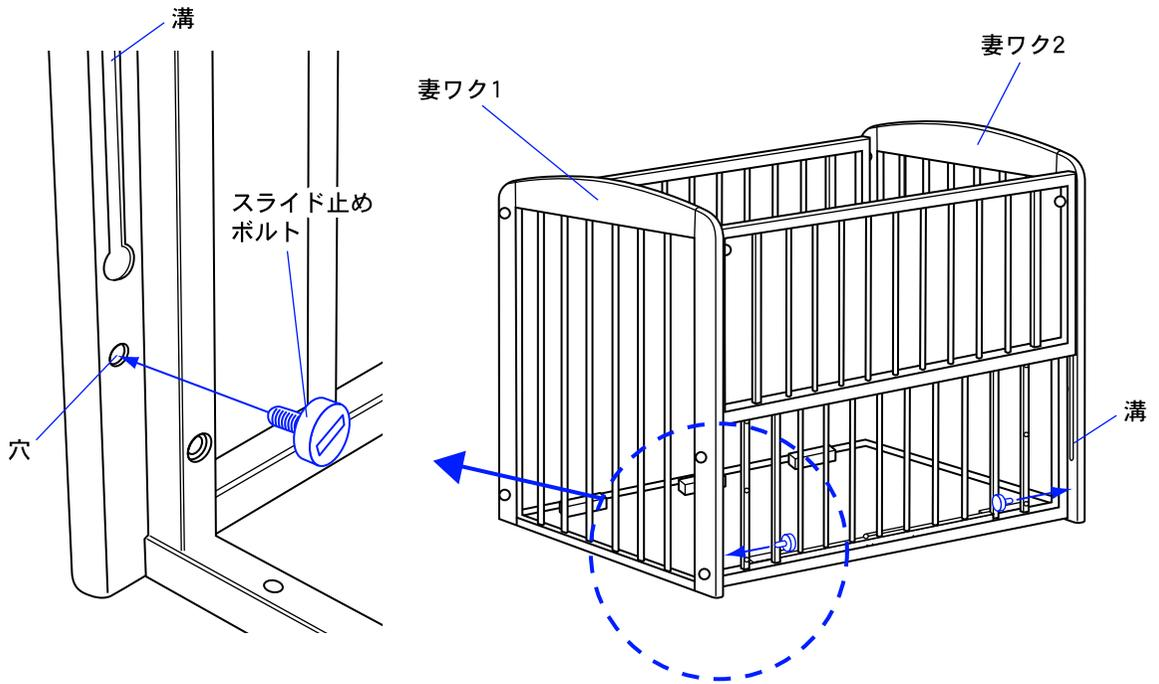
4. 妻ワク1と2の溝の下の穴にスライド止めボルトを取り付けてください。
