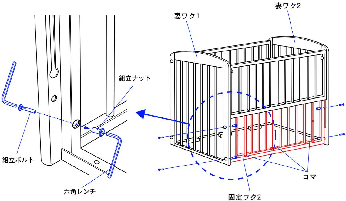
3. 妻ワク1と2に固定ワク2を組立ボルトと組立ナットで固定してください。
