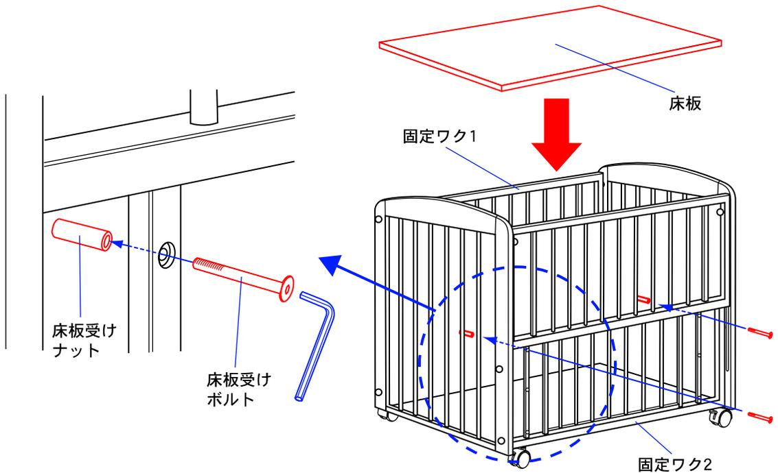
7. 床板受けボルトと床板受けナットを固定ワク1、2に取付けてください。(3段階調節)
