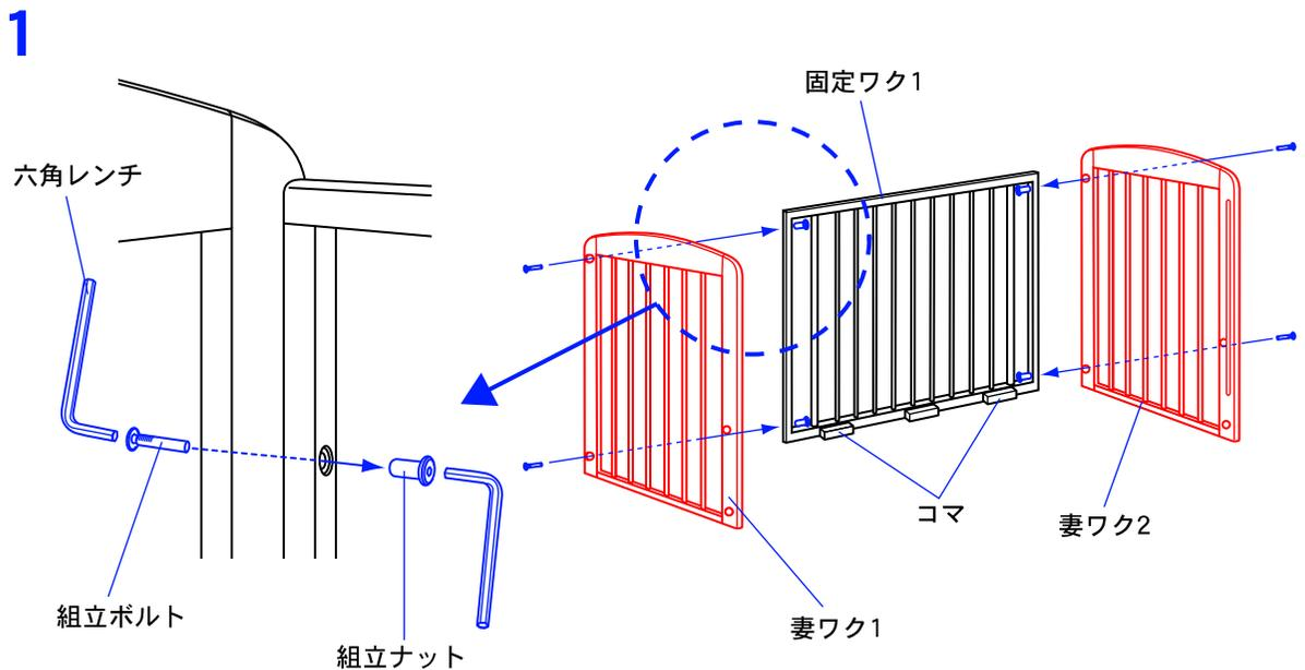
1. 妻ワク1と2を固定ワク1に組立ボルトと組立ナットで固定してください。
