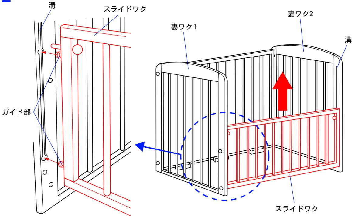
2. スライドワクのガイド部を図のように妻ワク1と2の溝の丸い部分に差し込み、スライドワクを上
