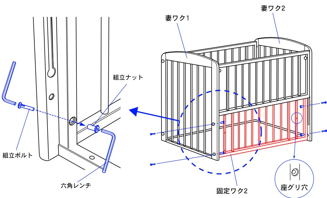
3. 妻ワク1と2に固定ワク2を組立ボルトと組立ナットで固定してください。
