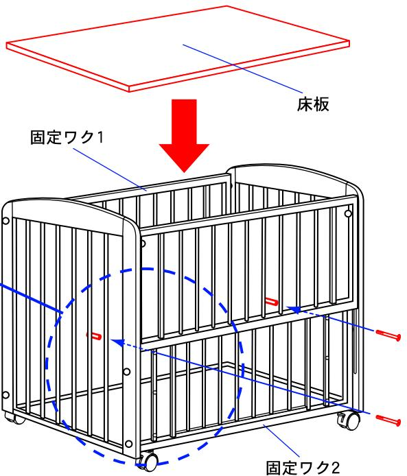
6. 床板受けボルトと床板受けナットを固定ワク1、2に取付けてください。 (3段階調節)
