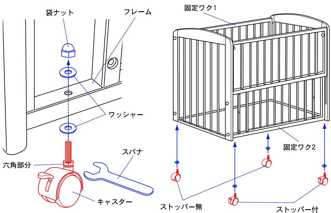
5. 固定ワク1と2の下のフレームにキャスターをワッシャーと袋ナットで取付けて下さい。
