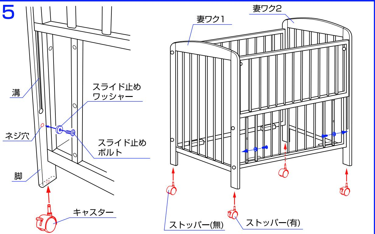
5. 妻ワク1と2の溝の下のネジ穴にスライド止めワッシャーをスライド止めボルトで固定して下さい。
