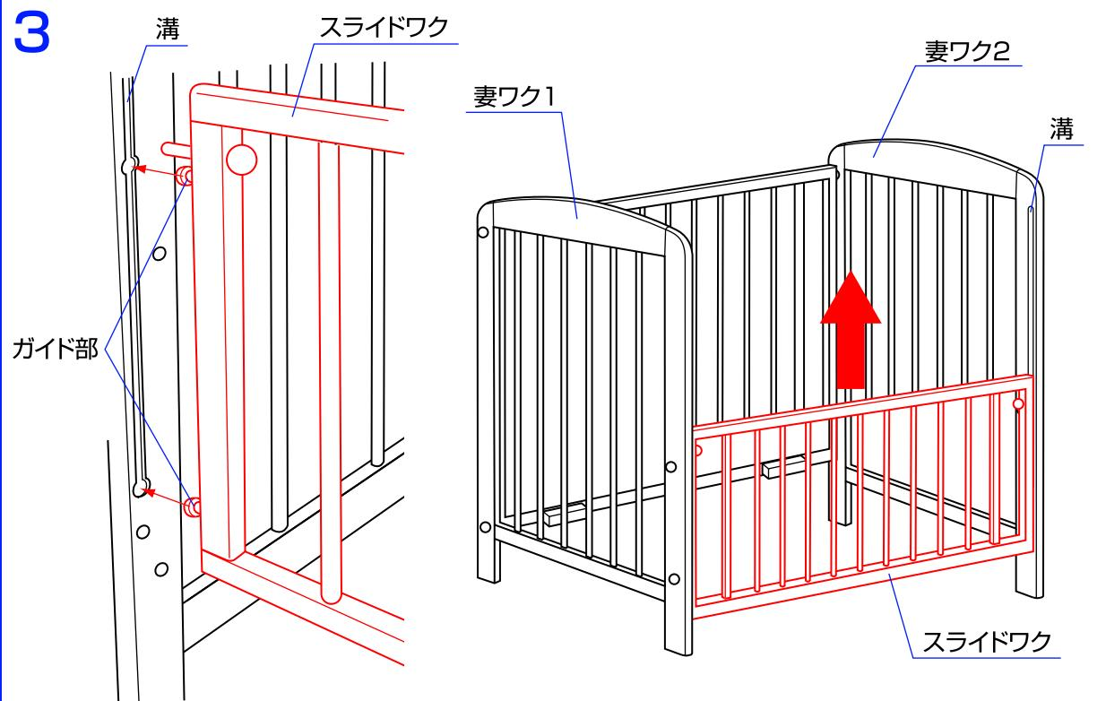
3.スライドワクのガイド部を図のように妻ワク1と2の溝の丸い部分に差し込み、スライドワクを上にスライドさせて下さい。
