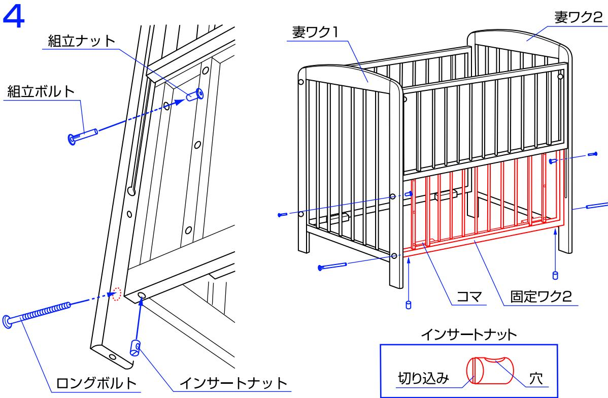
4. 妻ワク1と2と固定ワク2の上側の穴を組立ボルトと組立ナットで固定して下さい。
