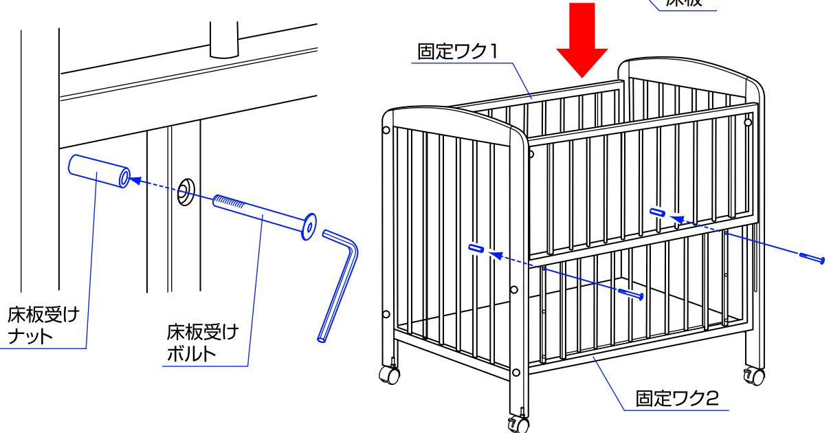
7. 床板受けボルトと床板受けナットを固定ワク1、2に取り付けて下さい。 (3段階調節)
