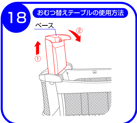
18.①おむつ替えテーブルのベースを引き上げ、②矢印の方向へ倒して下さい。
