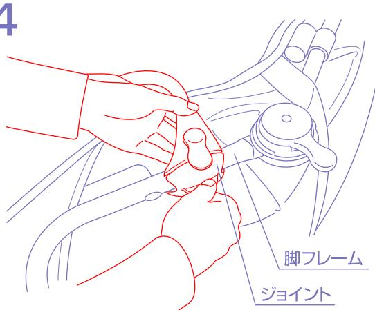
3.解除ボタンを押してジョイントを開き、本体の脚フレームの内側から取り付けて下さい。左右同じように取り付け下さい。
