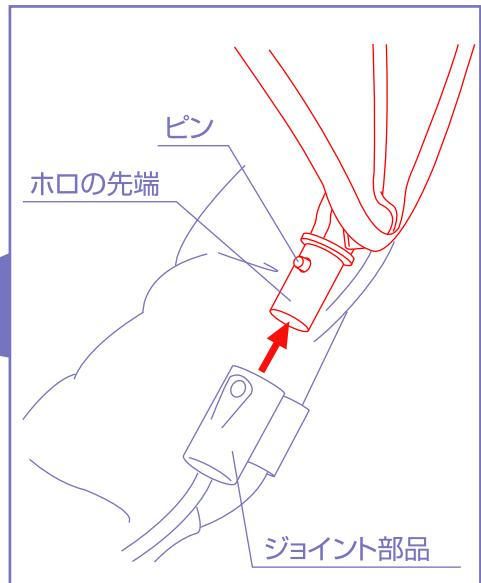
1.ホロとテーブルを取り外して下さい。ホロは先端のピンを押さえながらジョイント部品から取り外してください。
