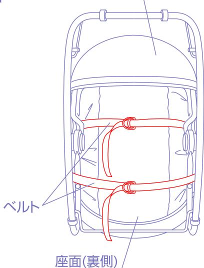
〈シート取付時のベルトの通し方〉
