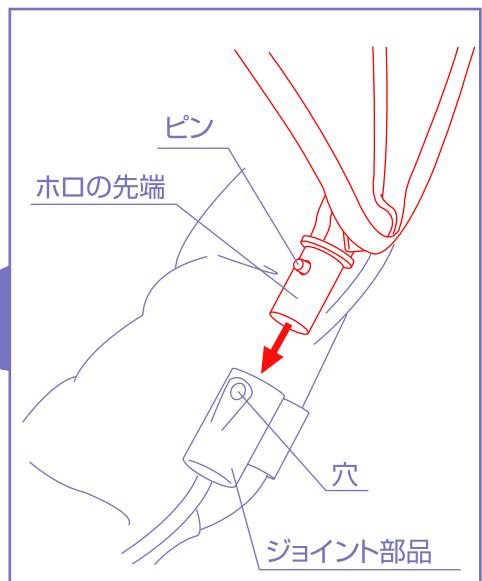
1 ホースを本体の背もたれにかぶせ、両側にあるホースの先端のピンを押さえながら、本体両側に付いているジョイント部品に差し込んで下さい。ホースのクリップを下げるで固定して下さい。
