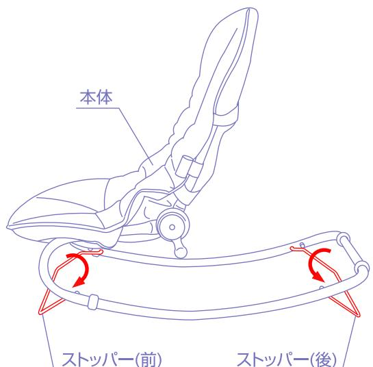
◇両側に付いている調節レバーを①の方向へ回転させると背もたれの角度を変えることができます。また、角度が決まつたら必ず両側の調節レバーを②の方向に回転させてロックして下さい。※使用する前に両側の調節レバーが確実にロックされているかどうか必ず確認して下さい。
