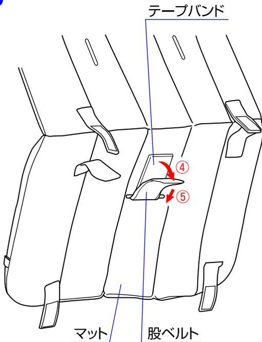
3. ④マットの裏側に固定されている股ベルトのテープバンドを外し、⑤股ベルトを表側から抜き取って下さい。
