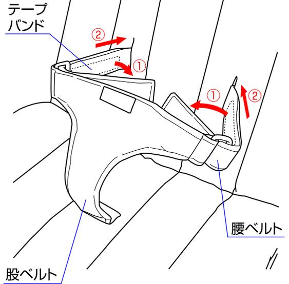
2. 洗濯時にシートベルトを取り外す場合は、①腰ベルトのテープバンドを外し、②腰ベルトをマットの裏側から抜き取って下さい。
