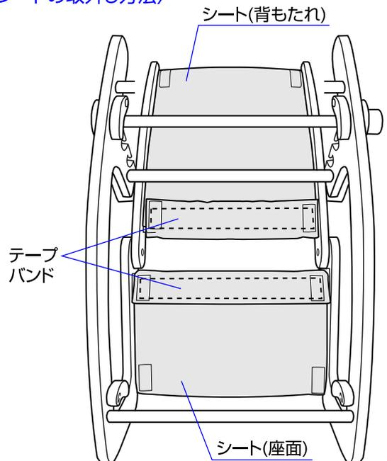
◇ シート(背もたれ・座面)のテープバンドを本体の裏側から取り外して下さい。(計2カ所)
