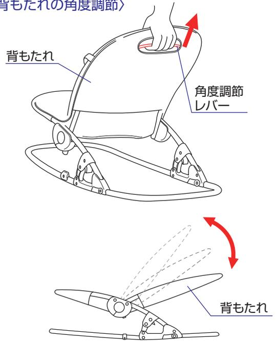
◇背もたれ裏側に付いている角度調節レバーを図のように引き上げながら、背もたれの角度を調節して下さい。(3段階調節)
