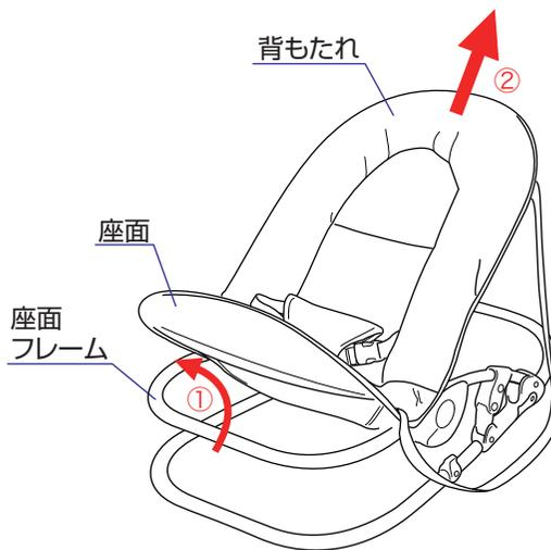
2. ①座面を座面フレームから取り外し、②背もたれを取り外して下さい。
