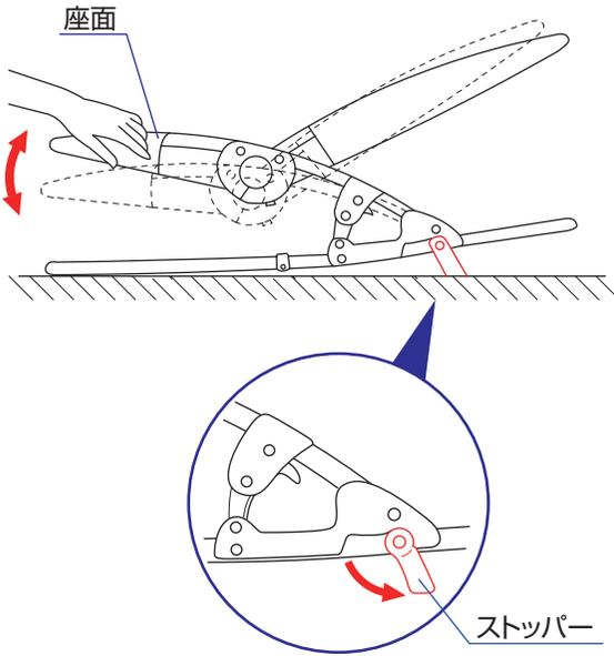
◇脚フレームの左右に付いているストッパーを出すと、ロッキングを止める事ができます。ストッパーを出した状態で座面を下に軽く押すとバウンドします。
