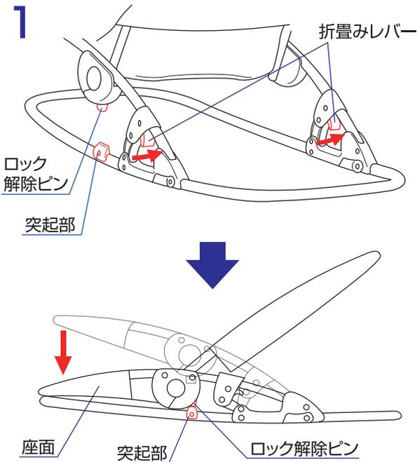
1. 左右の折畳みレバーを矢印方向に押し、シートの座面を折り畳んで下さい。※折り畳んだ時にロック解除ピンが突起部に押されていることを確認して下さい。
