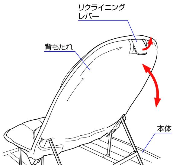
◇本体を押さえながらリクライニングレバーを上げ、背もたれの角度を調節して下さい。(3段階調節) ※背もたれの角度が確実に固定されていることを必ず確認して下さい。
