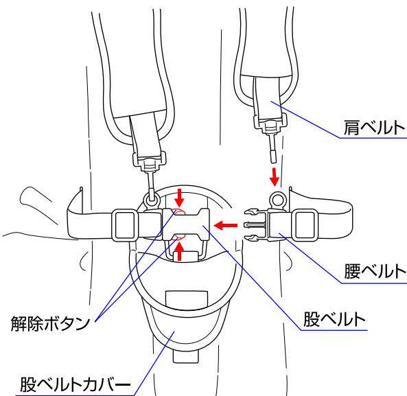
◇股ベルトカバーを開けて、肩ベルトを腰ベルトに取り付け、股ベルトに差し込んで下さい。腰ベルトを取り外す時は、解除ボタンを押して下さい。※本体を使用する時は必ずシートベルトを締めて使用して下さい。
