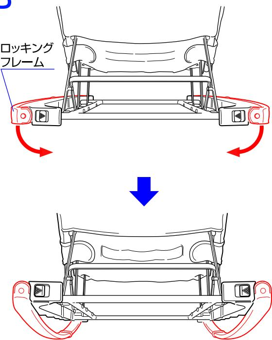
3.左右のロッキングフレームを矢印方向に回して図のようにして下さい。※ロッキングフレームが確実に固定されていることを必ず確認して下さい。
