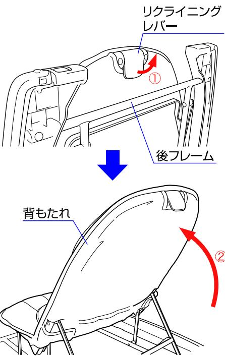
2.①後フレームを押さえて、背もたれ裏側のリクライニングレバーを引き、②背もたれが固定されるまで起こして下さい。※背もたれが確実に固定されていることを必ず確認して下さい。
