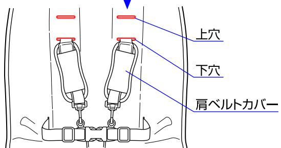
◇①肩ベルトカバーを外し、肩ベルトの先端を上穴に入れて、②肩ベルトの先端を下穴から出して下さい。
