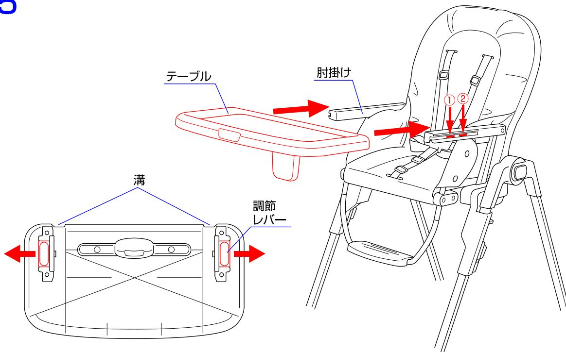
5. テーブル裏側の両側に付いている調節レバーを引きながら、テーブルの溝を本体の肘掛けに合わせて差し込んで取り付けて下さい。※テーブルは調節レバーを引くと位置を2段階に調節することができます。(①↔②)
