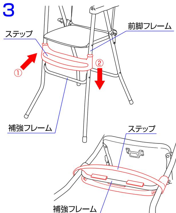
3.①ステップを前脚フレームに取り付けて下さい。
