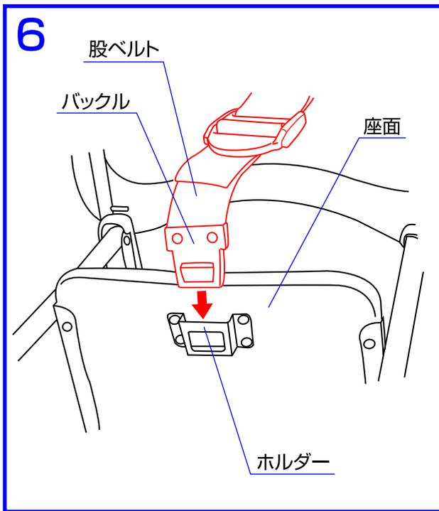
6.股ベルトのバックルを座面裏側のホルダーに差し
