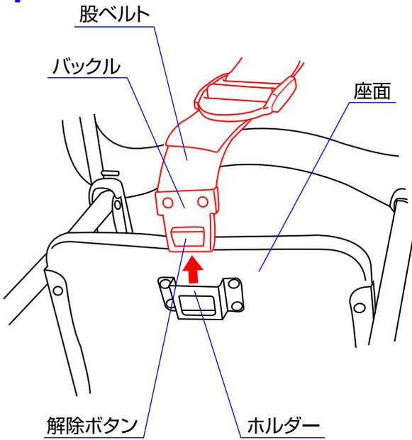
1. 股ベルトのバックルの解除ボタンを押して、座面裏側のホルダーから取り外して下さい。
