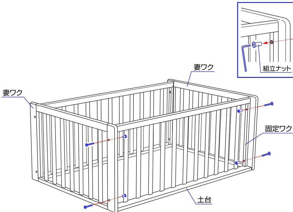
2. 妻ワクに固定ワクを組立ボルトMと組立ナットで取り付けして下さい。(組立ボルトとナットは六角レンチで固定して下さい。)
