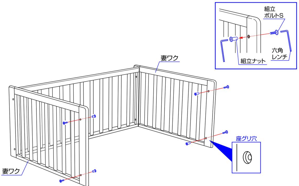
2.妻ワクの座グリ穴に組立ボルトSと組立ナットで穴を塞いで下さい。(組立ボルトとナットは六角レンチで固定して下さい。)
