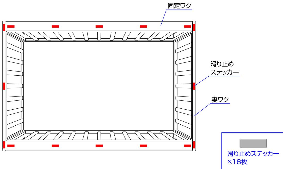
◇妻ワク、固定ワクの裏側に図のように滑り止めステッカーを貼って下さい。(計16枚)
