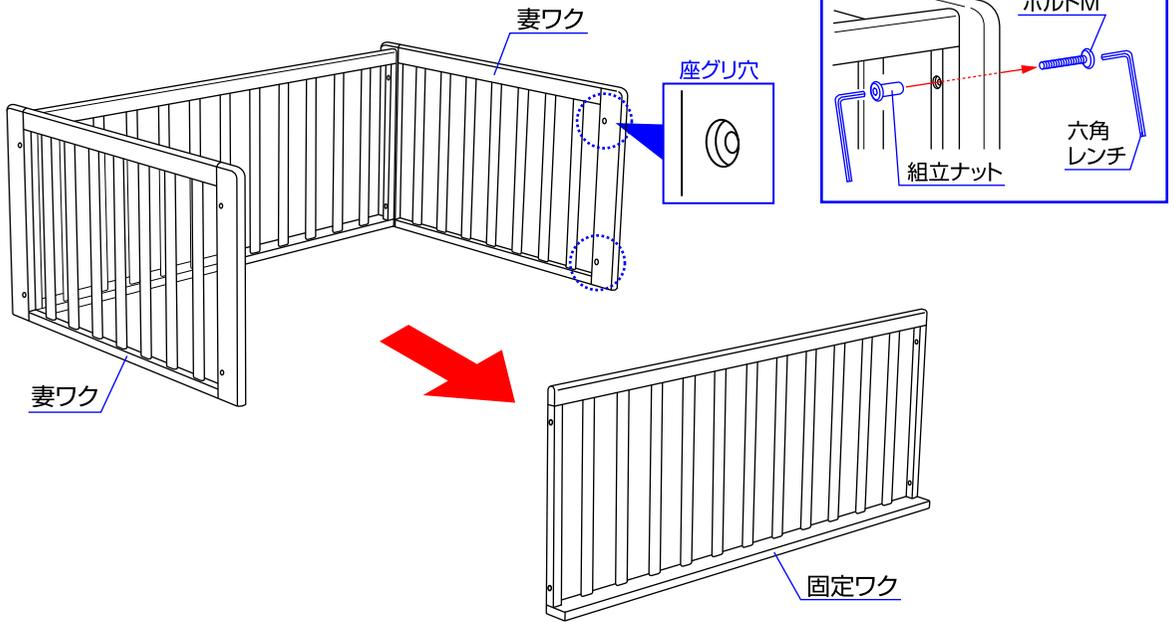
1.妻ワク内側にある座グリ穴の開いている方の固定ワクを取り外して下さい。組立ボルトMとナットは六角レンチで取り外して下さい。(組立ボルトM×4、固定ワクはお子様の手の届かない場所に大切に保管して下さい。)
