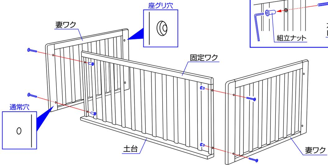
1. 妻ワクに固定ワクを組立ボルトMと組立ナットで取り付けして下さい。(組立ボルトとナットは六角レンチで固定して下さい。)
