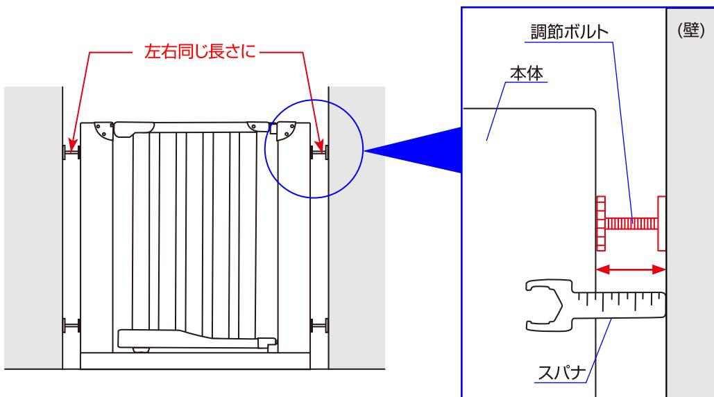
4.スパナに付いている目盛りを目安にして調節ボルトの長さを左右均等になるように調節して下さい。
