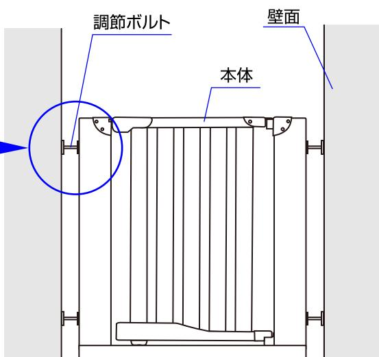
3.調節ボルトの溝にスパナのツメを引っ掛け、矢印の方向に回して調節ボルトを伸ばして下さい。
