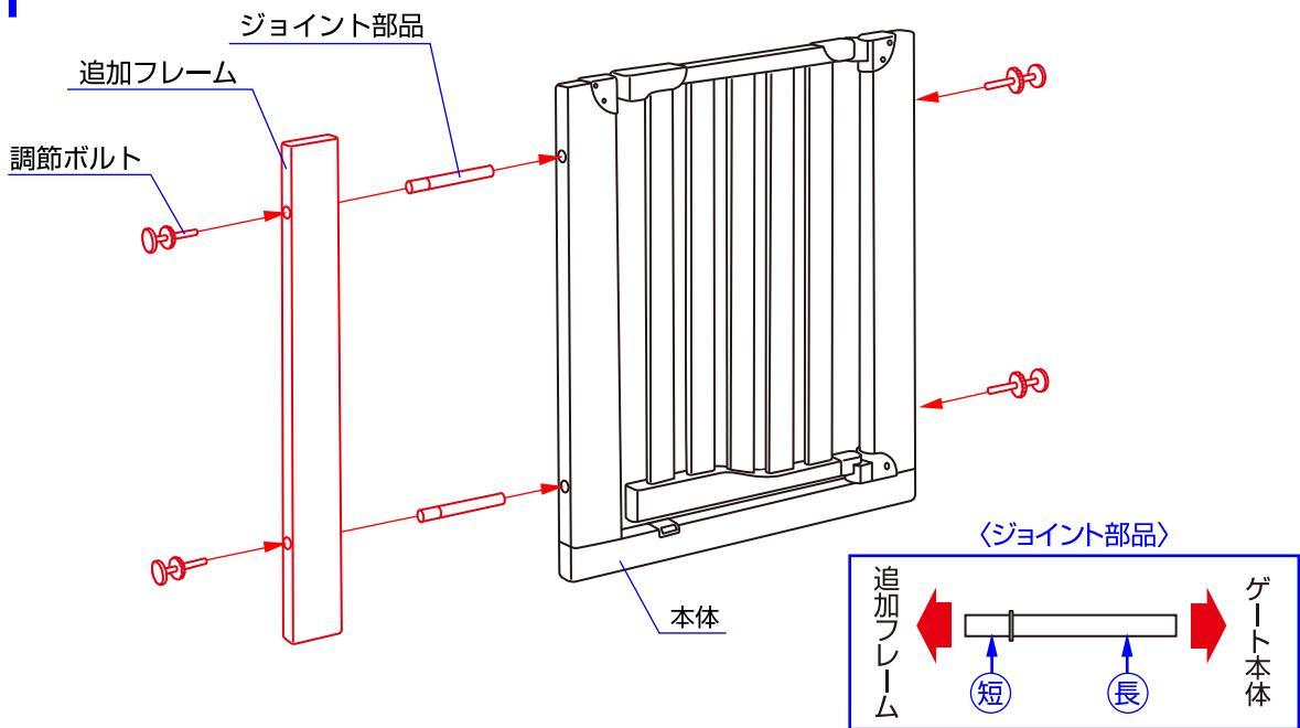
1. ジョイント部品の長い部分を本体に差し込み、短い部分を追加フレームに差し込んで下さい。
