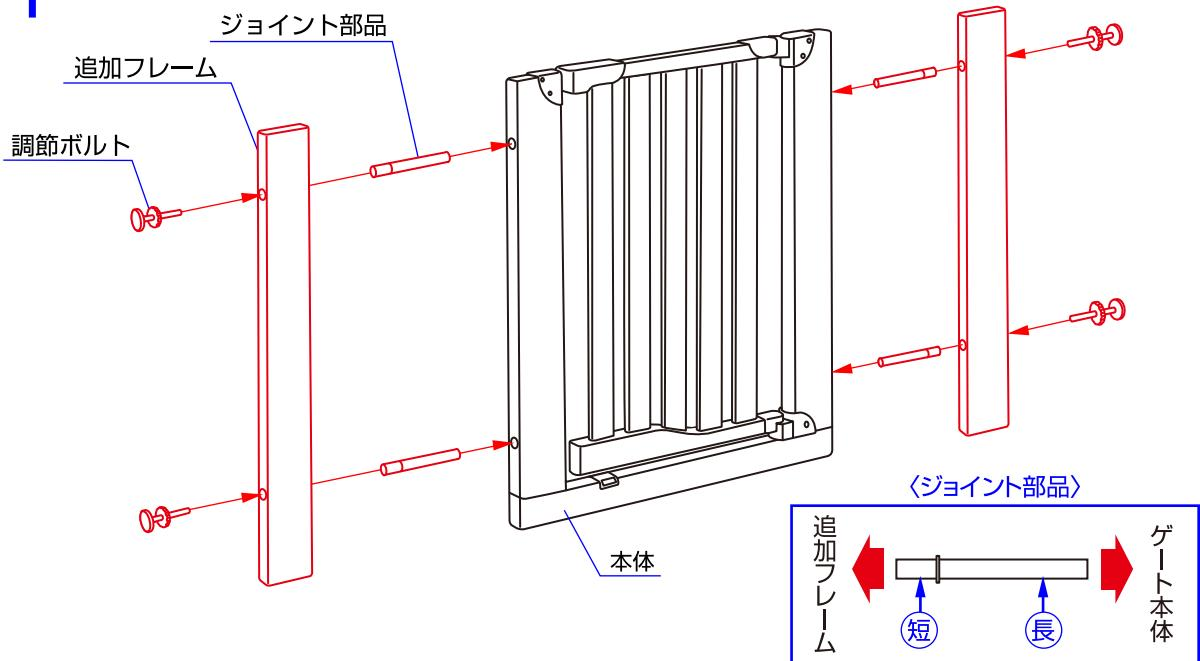
1. ジョイント部品の長い部分を本体に差し込み、短い部分を追加フレームに差し込んで下さい。追加フレームに調節ボルトを差し込んで下さい。※追加フレームの上下の向きに注意して下さい。
