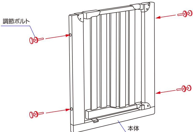
◇本体両側の穴に調節ボルトを差し込んで下さい。→ P3「取り付け方法」へお進み下さい。
