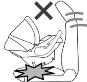
**本製品を取り付けた後に、自動車の座席のリクライニング操作、座席の移動をした場合には状態を確認すること**
