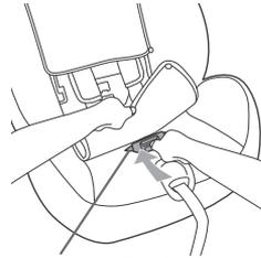
座面のカバーの切り込み部分に、受けバックルを押し込んで反対側に抜き出します。
