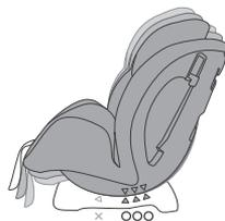
シェルの▽の印を、ベースの赤い△の位置のいずれかに合わせます。チャイルドモードでは、すべての赤い△の位置でご使用いただけます。
