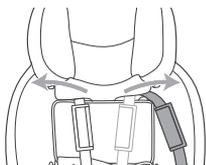
05 中の衝撃吸収材を傷つけないように注意しながら、カバーを留めつけているゴムバンドをフックから取り外します。ゴムバンドは、ヘッドレストの左右についていますので、左右とも取り外してください。
