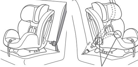
自動車腰ベルトが左右のボックスロットを通っている
