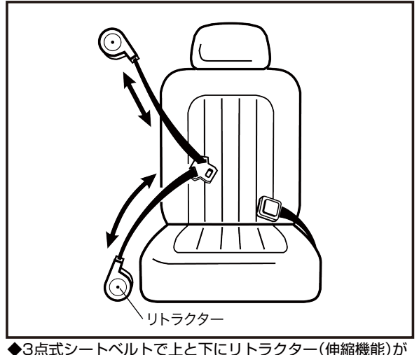
◆3点式シートベルトで上と下にリトラクター（伸縮機能）が付いているシートベルト※通常の車両は上側から出ている方だけにリトラクターが付いています。
